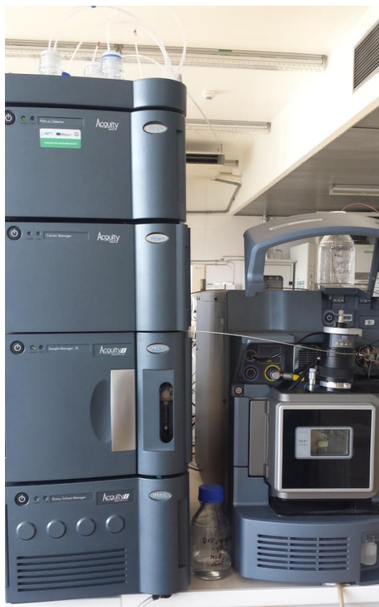
Obr. 2: UHPLC systém ve spojení s hmotnostním spektrometrem
