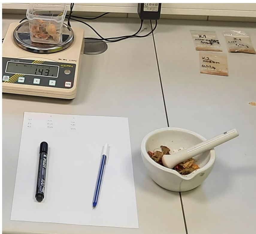
Obr. 18: Drcení vzorků. Elektronická váha, laboratorní miska, tlouček. (foto autor).
