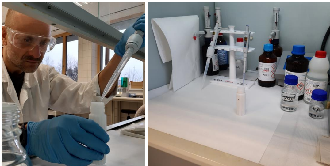
Obr. 20: Pipetování kyseliny dusičné a peroxidu vodíku do vzorku v teflonové zkumavce. Interiér laboratorní digestoře. (foto autor).
