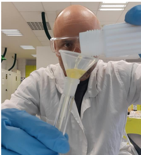
Obr. 22: Konečná příprava vzorku. Ředění destilovanou vodou ve skleněné zkumavce. (foto autor).
