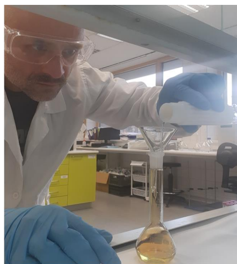
Obr. 22: Konečná příprava vzorku. Ředění destilovanou vodou ve skleněné zkumavce. (foto autor).
