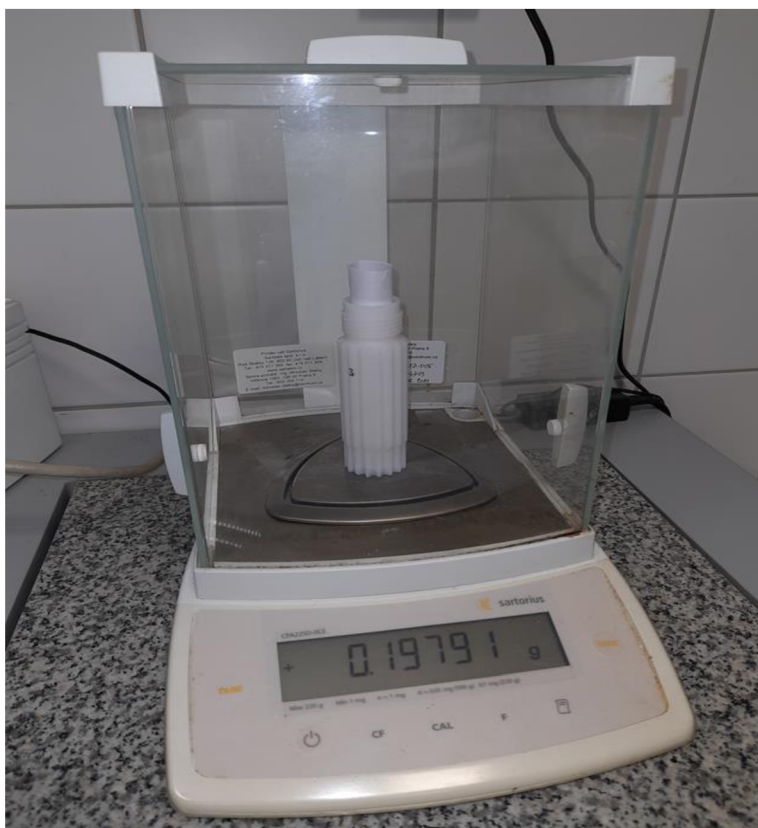
Obr. 19: Vážení vzorku v reakční teflonové zkumavce HVT50. (foto autor).
