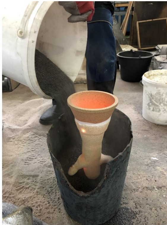
Obr. 34 - Zasypávání skořepiny ocelovými broky
