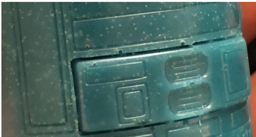
Obr. 29 - Povrchové bublinky zapříčiněné přepáleným voskem
