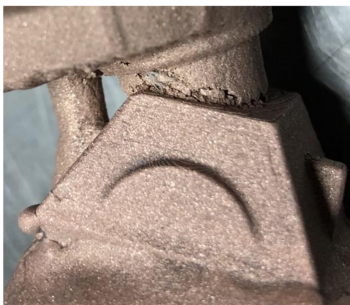
Obr. 35 - Detail trhliny nohy
