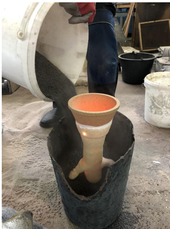
Obr. 34 - Zasypávání skořepiny ocelovými broky
