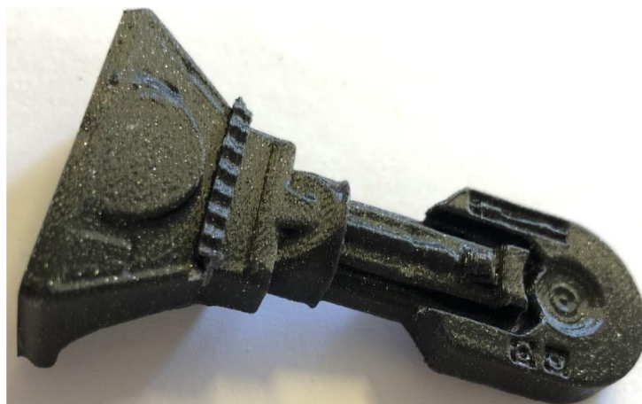
Obr. 24 - Vyhlazený model FDM
