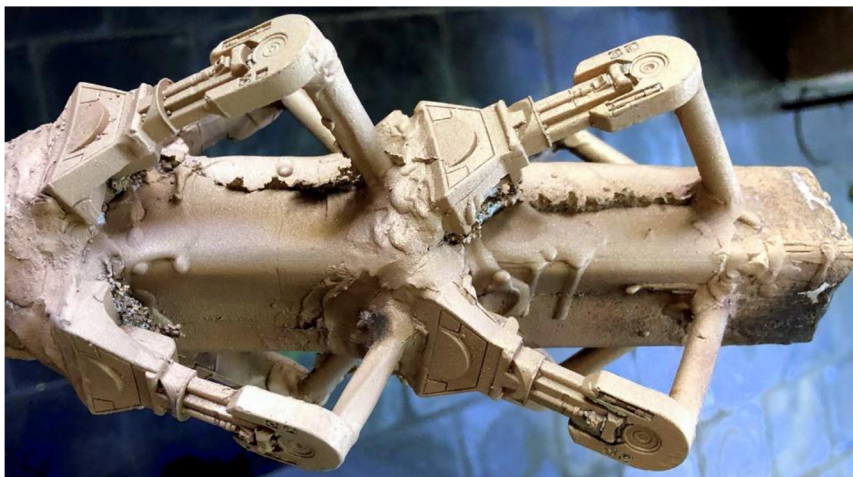
Obr. 41 - Výsledný odlitek nožiček
