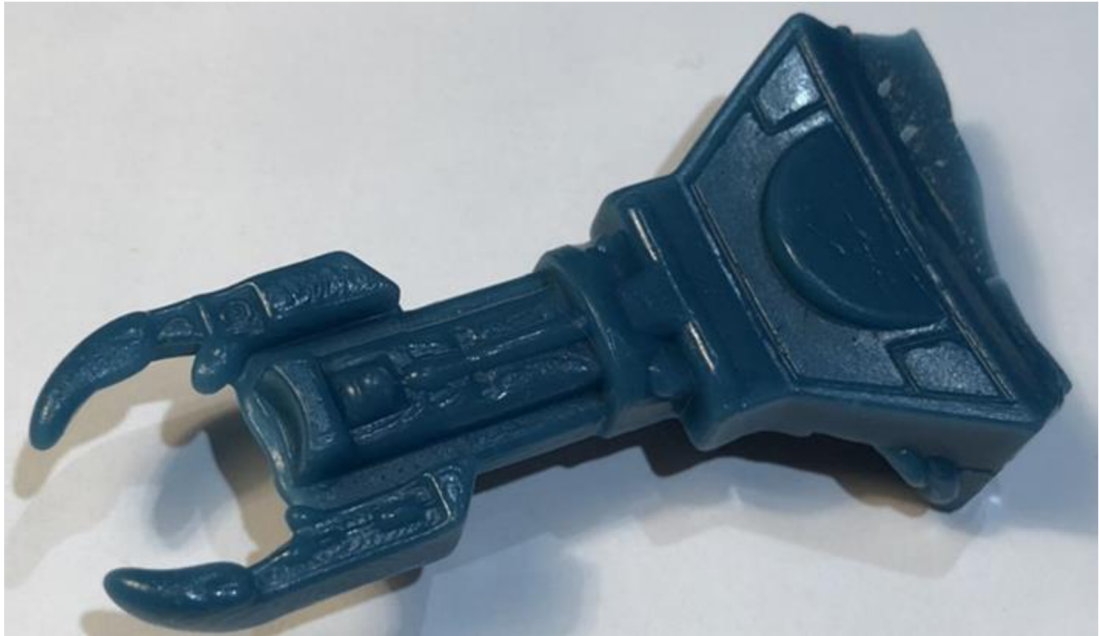
Obr. 28 - Špatně odlitá nožička
