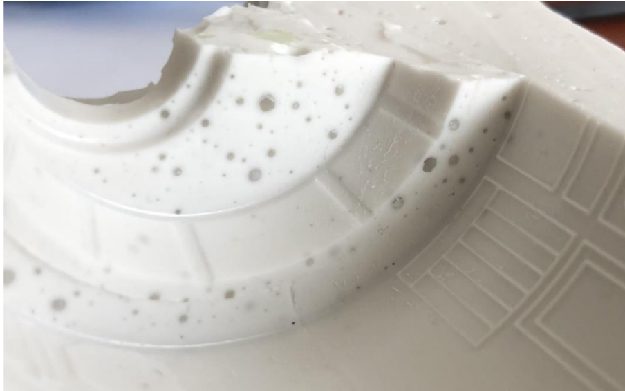
Obr. 26 - Vzduchové bubliny v kavitě formy
