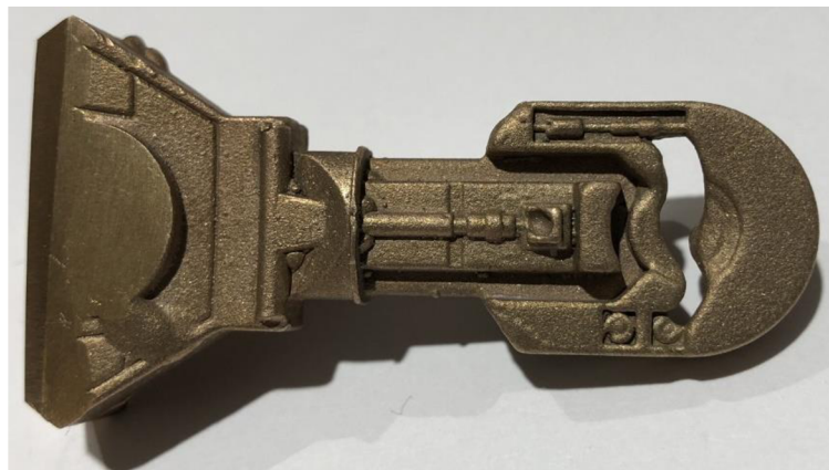
Obr. 39 - Dolitá nožička s menším nedostatkem
