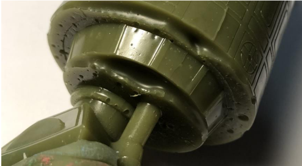
Obr. 30 - Kavity na povrchu modelu
