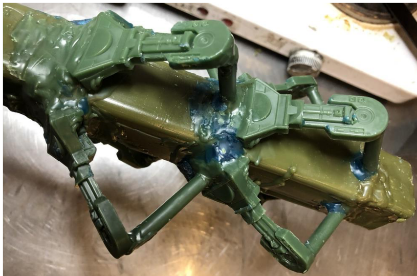
Obr. 40 - Výsledný stromeček se vtokovými kanálky
