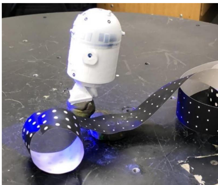
Obr. 18 - Připravený díl pro skenování
