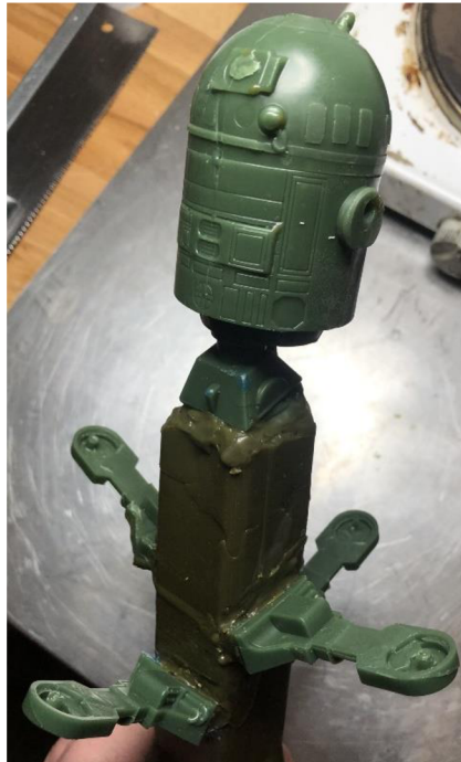
Obr. 32 - Výsledné voskové modely připájené ke vtokovému kanálu
