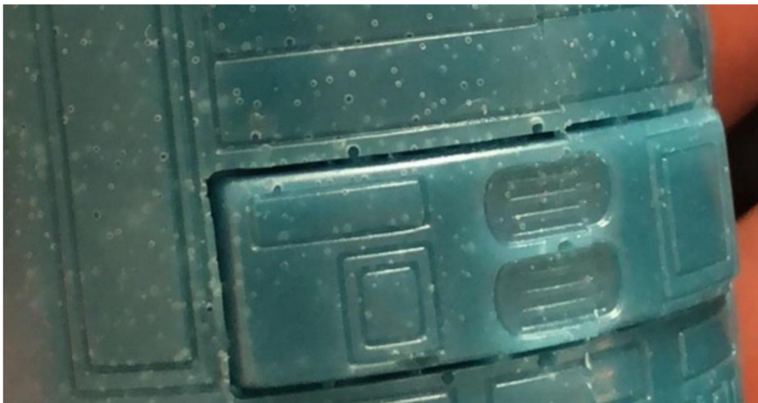
Obr. 29 - Povrchové bublinky zapříčiněné přepálením voskem
