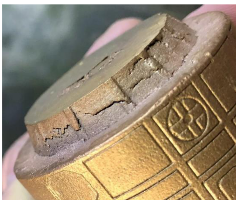
Obr. 36 - Detail staženiny s trhlinami na spodní části těla
