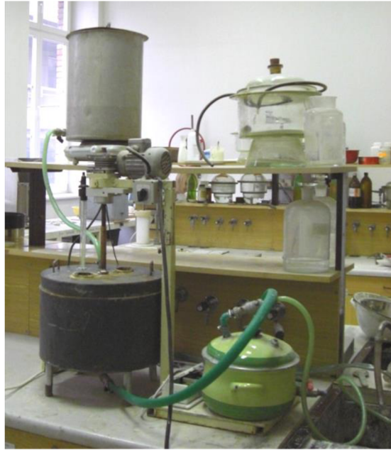
Obr. 18: II. verze laboratorního přístroje na výrobu \alpha – sádry ve vznosu
