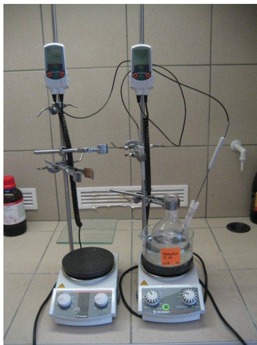
Obrázek 7 - Aparatura ke štěpení HA
