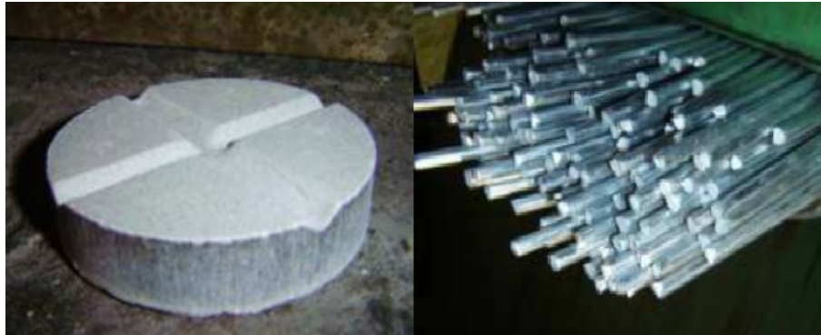
Obrázek 5.2: Očkovacia tableta SIMODAL 91 a očkovacia predzliatina AlTi5B1 vo forme drátu. [22]
