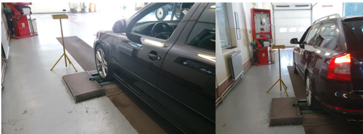
Obrázek 4.15: Kontrola brzdné síly na přední a zadní nápravě (v pozadí ukazatel brzdné síly)
