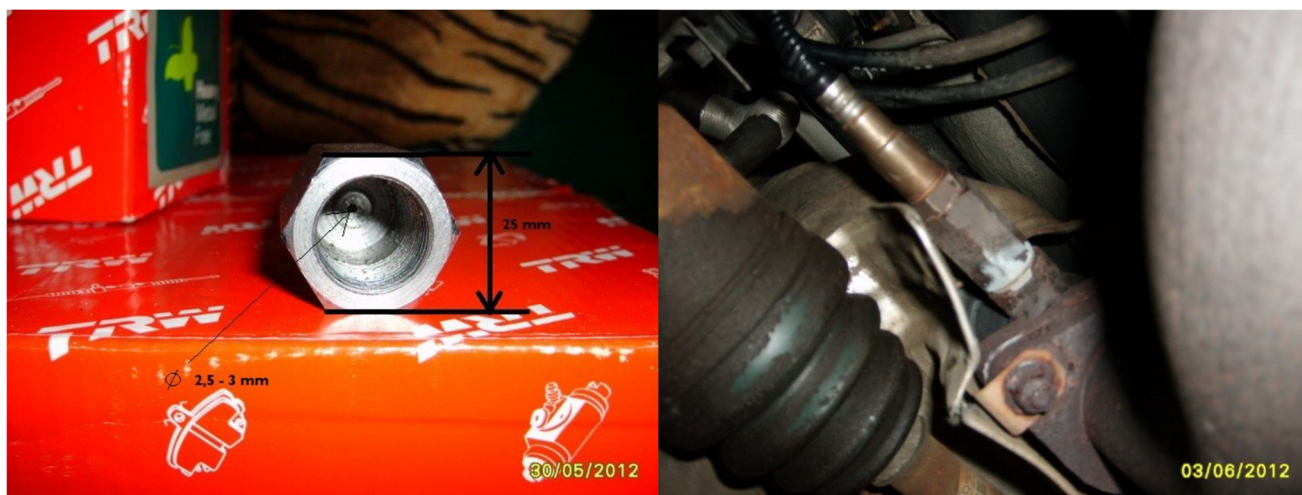
Obrázek 4.1: Mezikus kontrolní lambda sondy za katalyzátorem otupující její reakci (Metodika SME, 2020)
