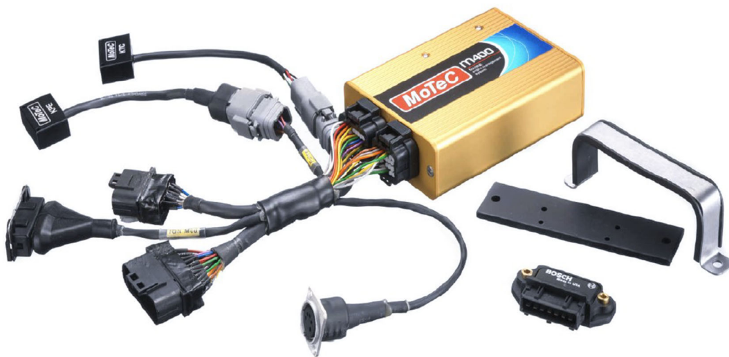
Obrázek 4.2: Závodní řídicí jednotka MoTeC se základním příslušenstvím a přechodovým kabelovým mezikusem pro napojení na původní elektroinstalaci vozidla, (Metodika SME 2020)
