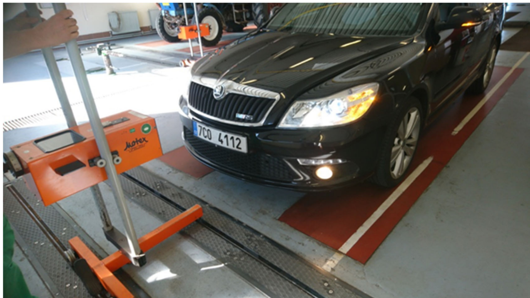
Obrázek 4.18: Zkouška a případné seřízení hlavních světlometů regloskopem
