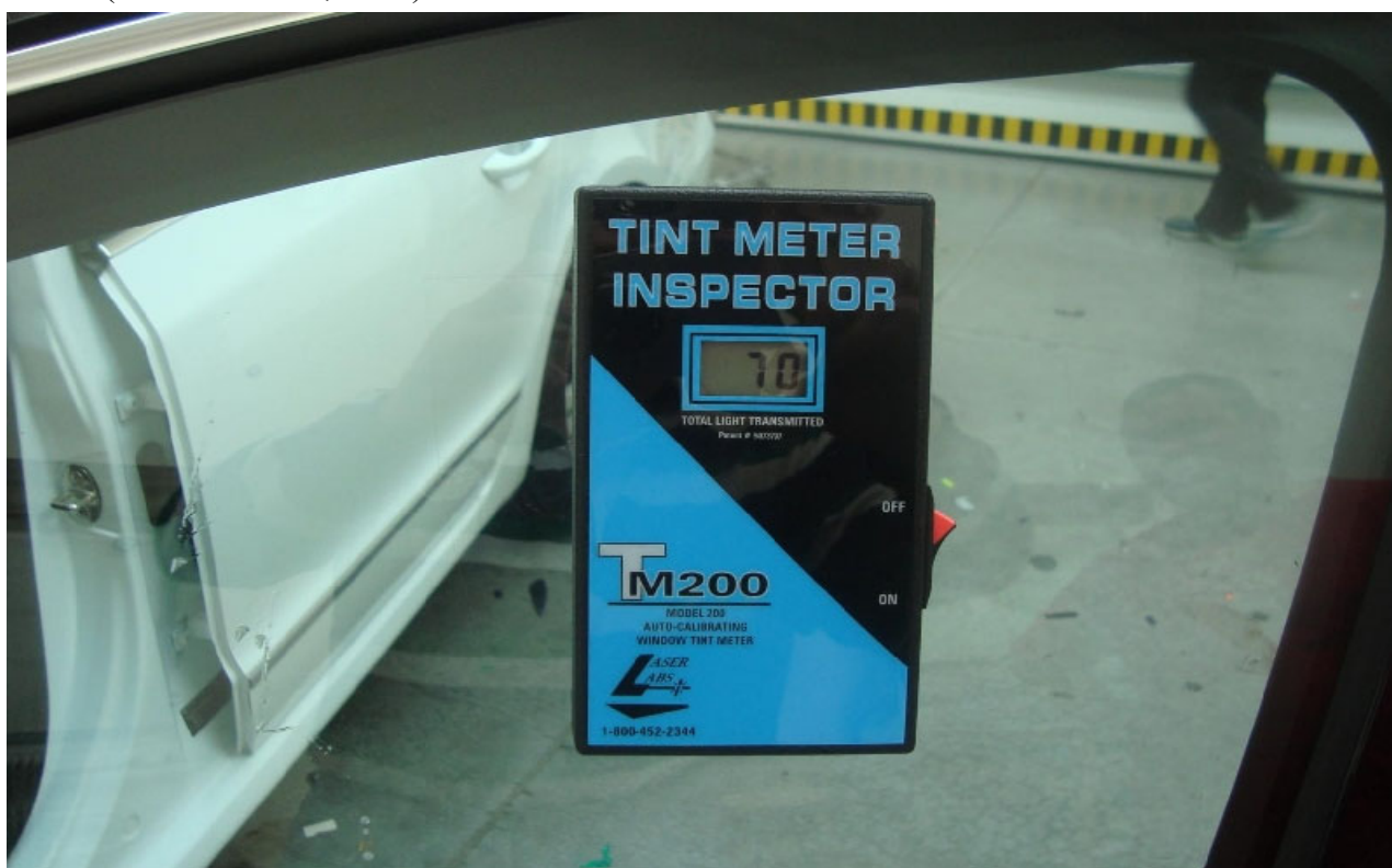
Obrázek 4.17: Měření světelné propustnosti auto skla tint-metrem
