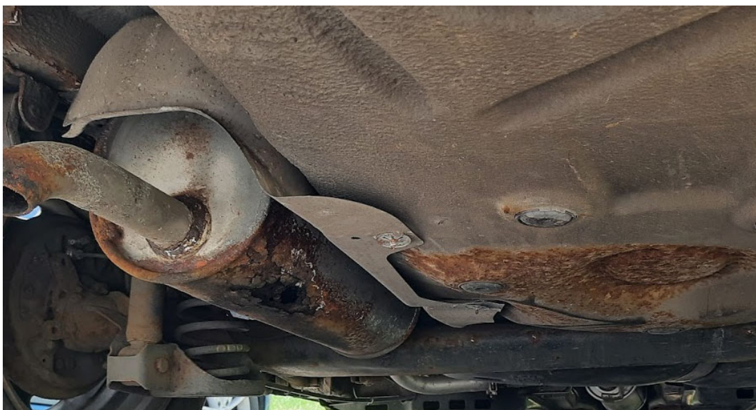
Obrázek 4.21: Nadměrná hlučnost vozu způsobená vyhnílou částí výfuku.
