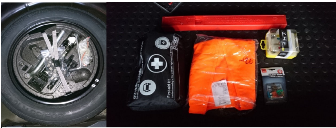
Obrázek 4.20: Kontrola přítomnosti rezervního dojezdového kola (opravné sady pneumatik) a povinné výbavy
