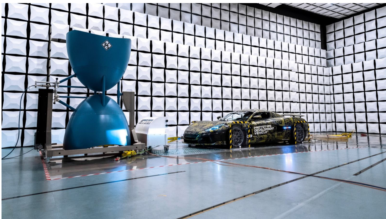
Obrázek 5.2: Vůz C_Two společnosti Rimac v průběhu homologační procedury ve zvukotěsné komoře, která je akusticky i elektromagneticky odstíněna, aby byly zaručeny co nejpřesnější výsledky. Vozy jsou zde pak řízeny na dynamometru (Prokopec, 2020).
