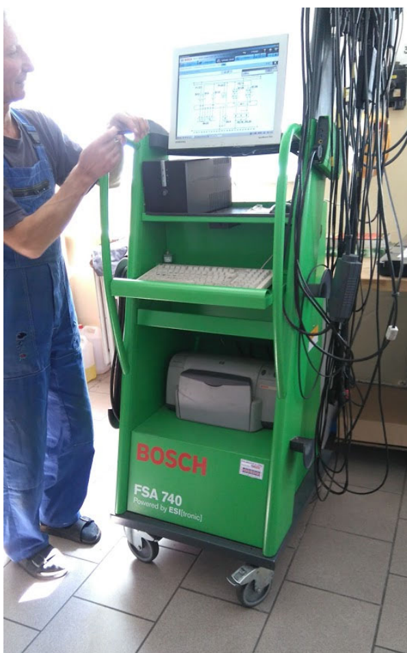
Obrázek 1.11: Schválené diagnostické zařízení pro měření emisí Bosch FSA 740
