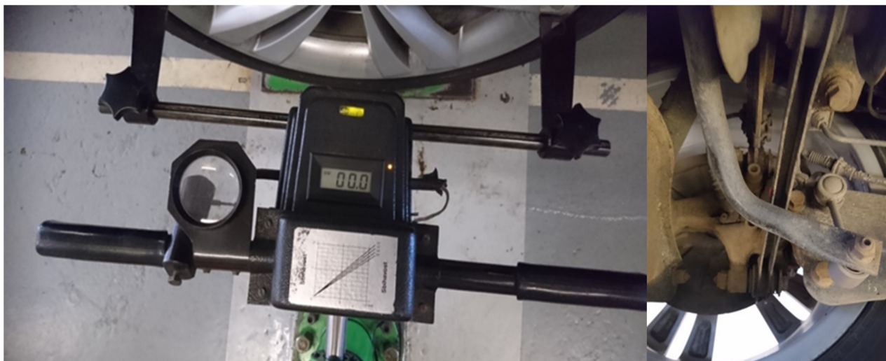
Obrázek 4.16: Kontrola odklonu roviny kola a prvků seřízení geometrie řízení
