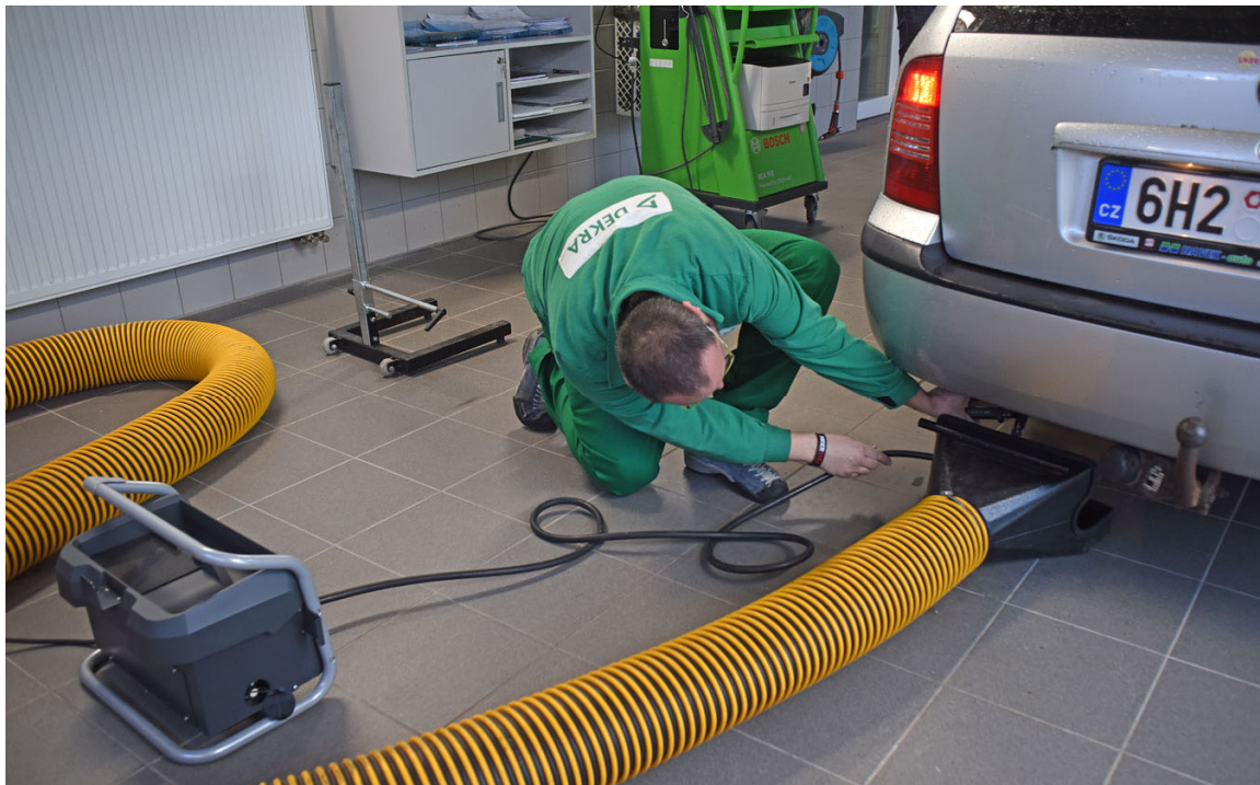
Obrázek 4.3: Kontrola analyzátozem výfukových plynů (Mára, 2020)
