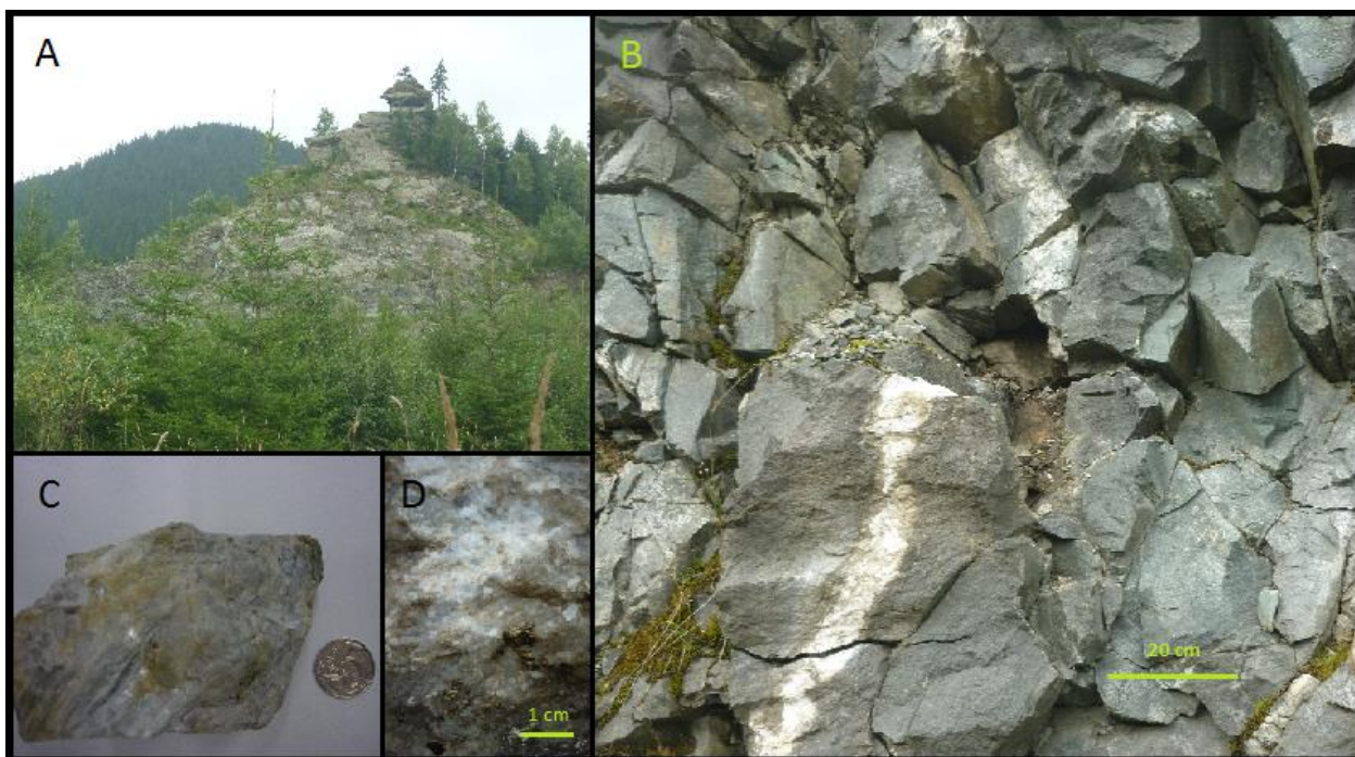
Obr. 10 – Pohled na lom Zámčisko (A); pozice křemen-karbonát-barytové mineralizace obklopené bazickým žilným tělesem (B); odebraný vzorek ZÁM1 žiloviny s barytem, kalcitem a křemenem (C); individua pyritu uzavřená v kalcitu ve vzorku ZÁM1 (D).
