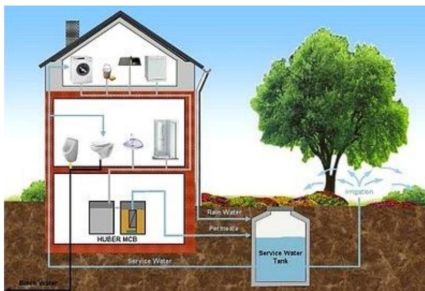
Obr. 8 - Využití kombinace šedé i dešťové vody v rodinném domě (Mířková, Ošlejšková 2011)
