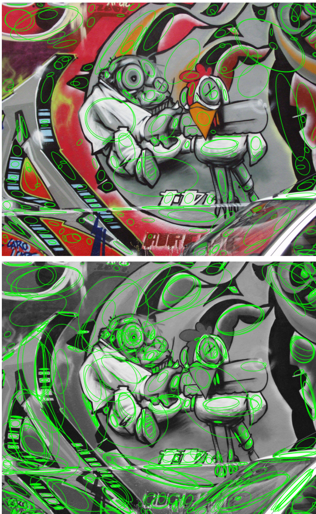
Obrázek 3.1: Porovnání detekce regionů v barevném a grayscale obrázku algoritmem MSER se shodným nastavením.
