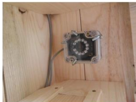
Obrázek 11. Přichycení horní kamery šroubovacími háky, kabel protažen otvorem do technické komory společně s kabelem IR brány (Zárybnická unpublik. data).
