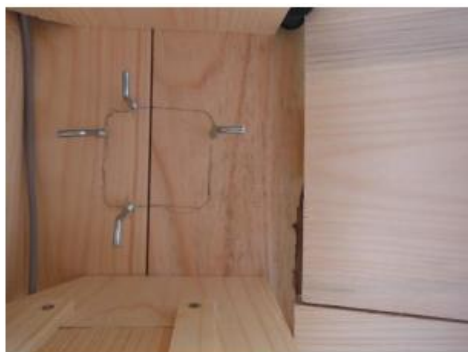
Obrázek 11. Přichycení horní kamery šroubovacími háky, kabel protažen otvorem do technické komory společně s kabelem IR brány (Zárybnická unpublik. data).
