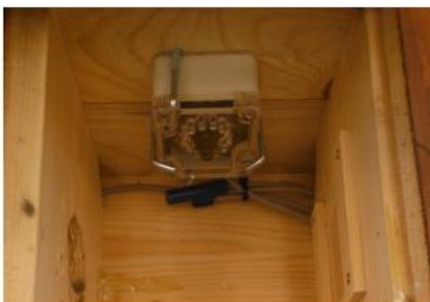
Obrázek 12. Teplotní čidlo, mikrofon a senzor intenzity světla jsou umístěny poblíž kamery (Zárybnická unpublik. data).
