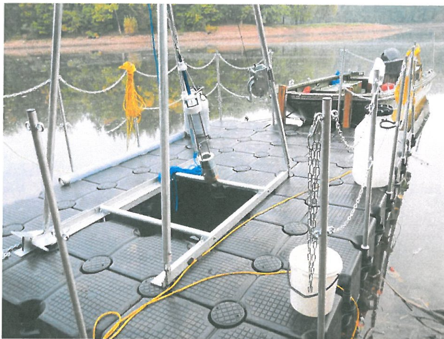
Foto 1: Pístový vzorkovač UWITEC (Niederreiter, Rakousko)
