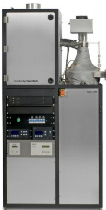
Obr. 3.5: Zařízení Fiji 2000 specializované na depozici atomárních vrstev [44].
