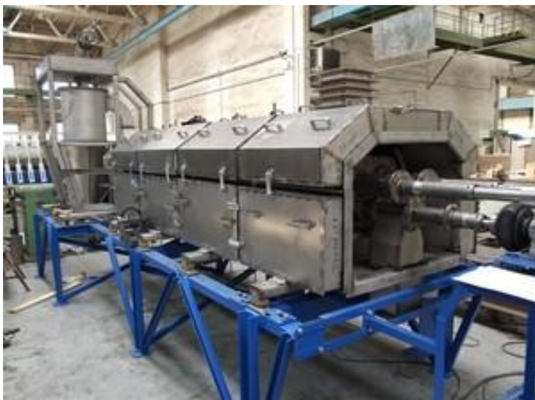
Obrázek 4 Zařízení Pyromatic na pyrolýzní zpracování komunálních odpadů [25]
