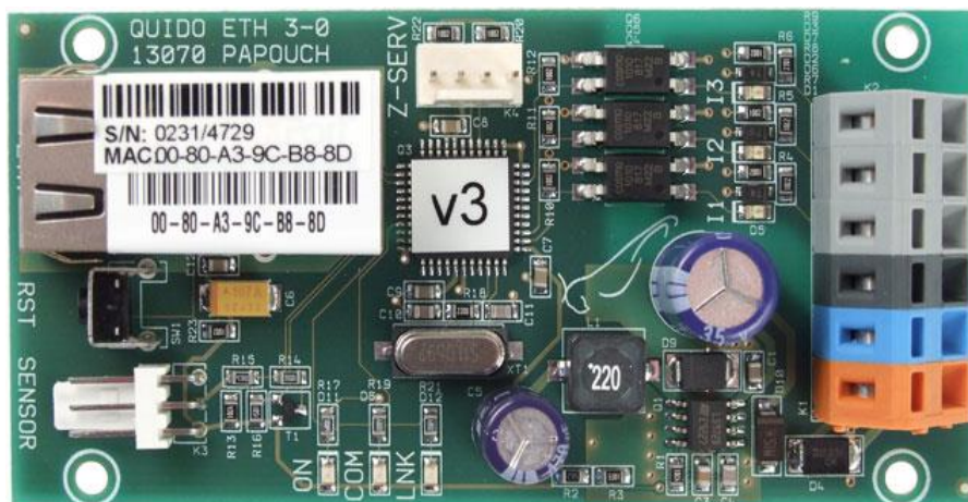
Obrázek 5 Elekroměr Quido ETH 3/0 má 3 digitální vstupy a teploměr
