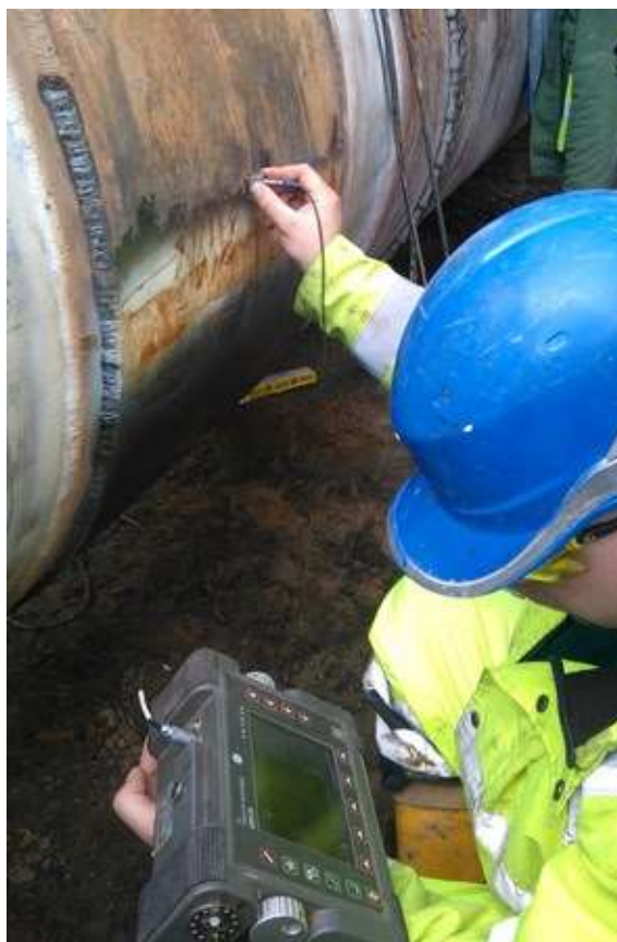
Obr. 4.5 Zkouška ultrazvukem (UT) [42]
