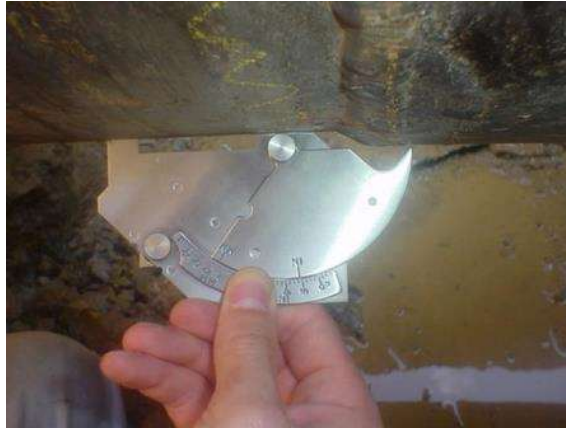
Obr. 4.1 Vizualní zkouška (VT) [38]
