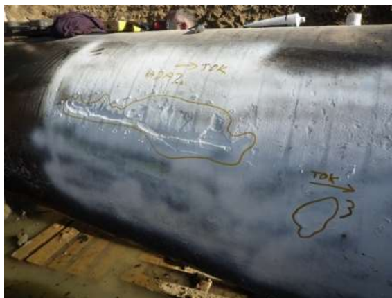
Obr. 4.2 Penetračně kapilární zkouška (PT) [39]
