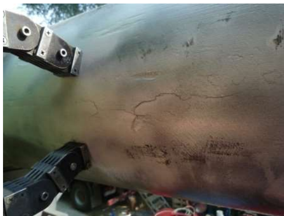
Obr. 4.3 Magnetická prášková zkouška (MT) [40]
