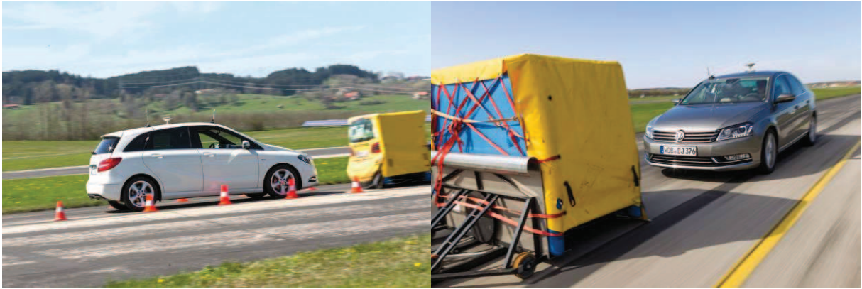
Obrázek 41, Testování zastavení vozidla před bariérou, zdroj: [19]
