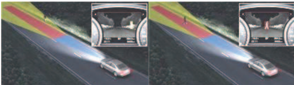
Obrázek 29, Systém nočního vidění s funkcí rozpoznání chodce, zdroj: [18]
