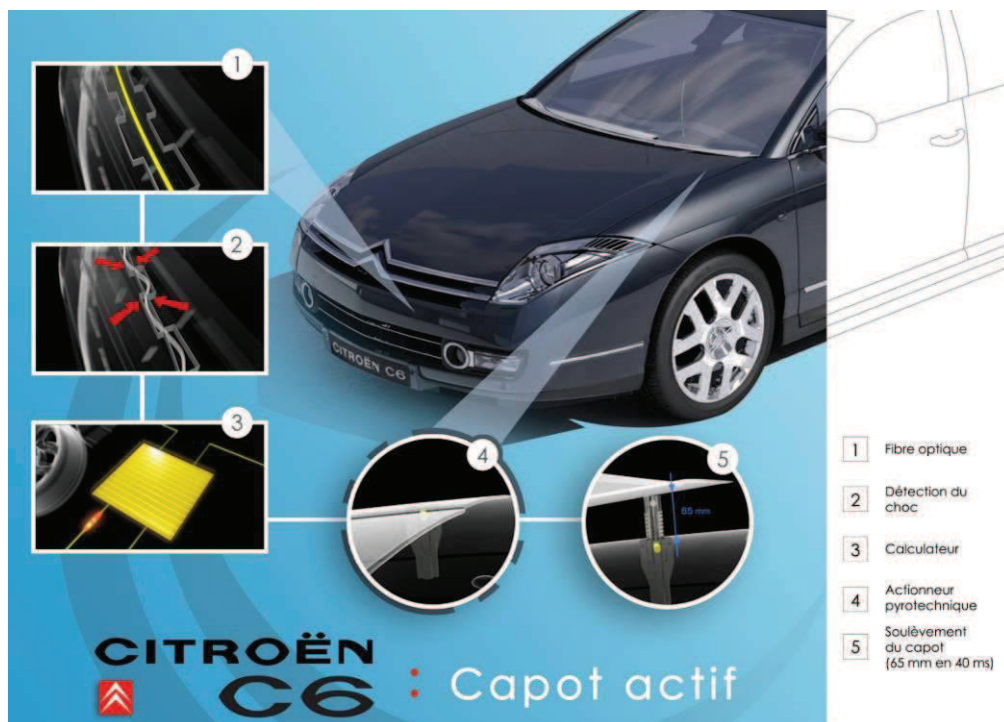
Obrázek 14, Řešení aktivní kapoty Citroënu C6, 1-optické vlákno, 2-detekování nárazu, 3-řídící jednotka, 4-pyrotechnický pohon, 5-zvednutí kapoty (65mm za 40ms), zdroj: [11]
