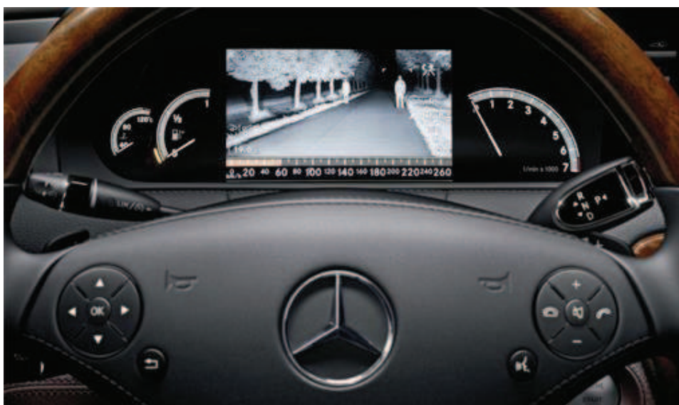
Obrázek 28, Aktivní systém nočního vidění Mercedes-Benz, zdroj: [18]
