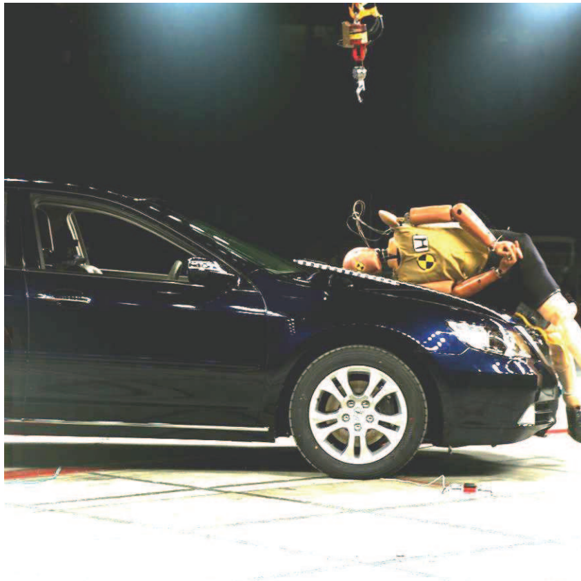
Obrázek 13, Princip aktivní kapoty, zdroj: [11]
