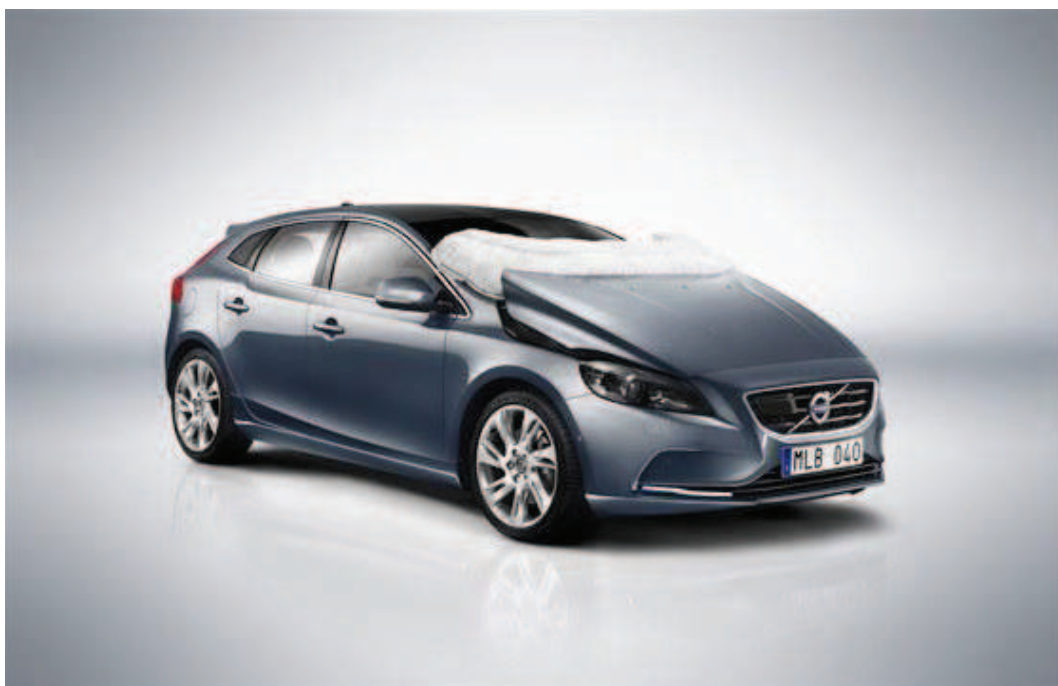
Obrázek 18, Externí airbag – Volvo V40, zdroj: [12]
