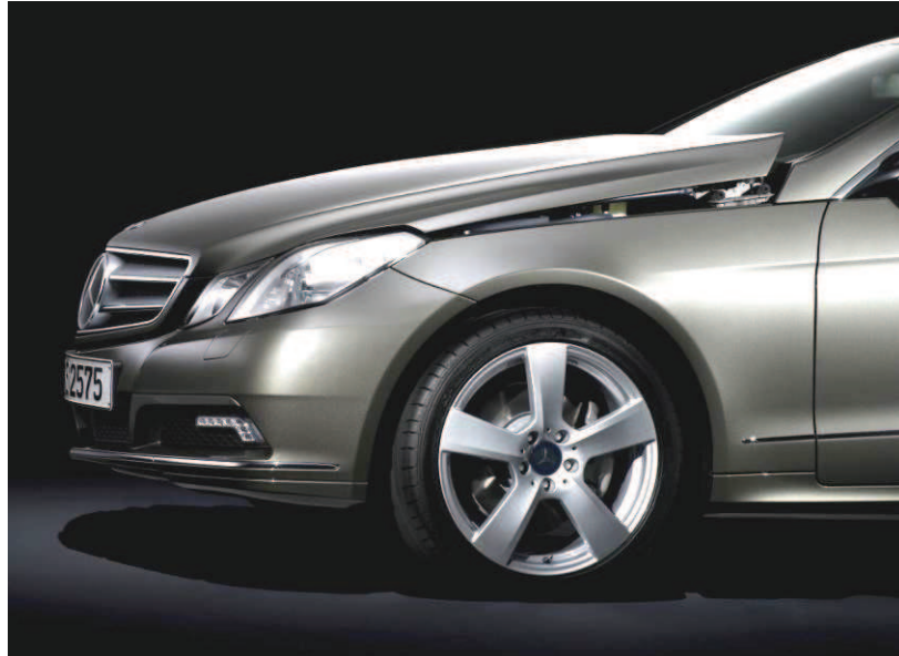
Obrázek 16, Aktivní kapota - Mercedes-Benz E (W212), zdroj: [11]
