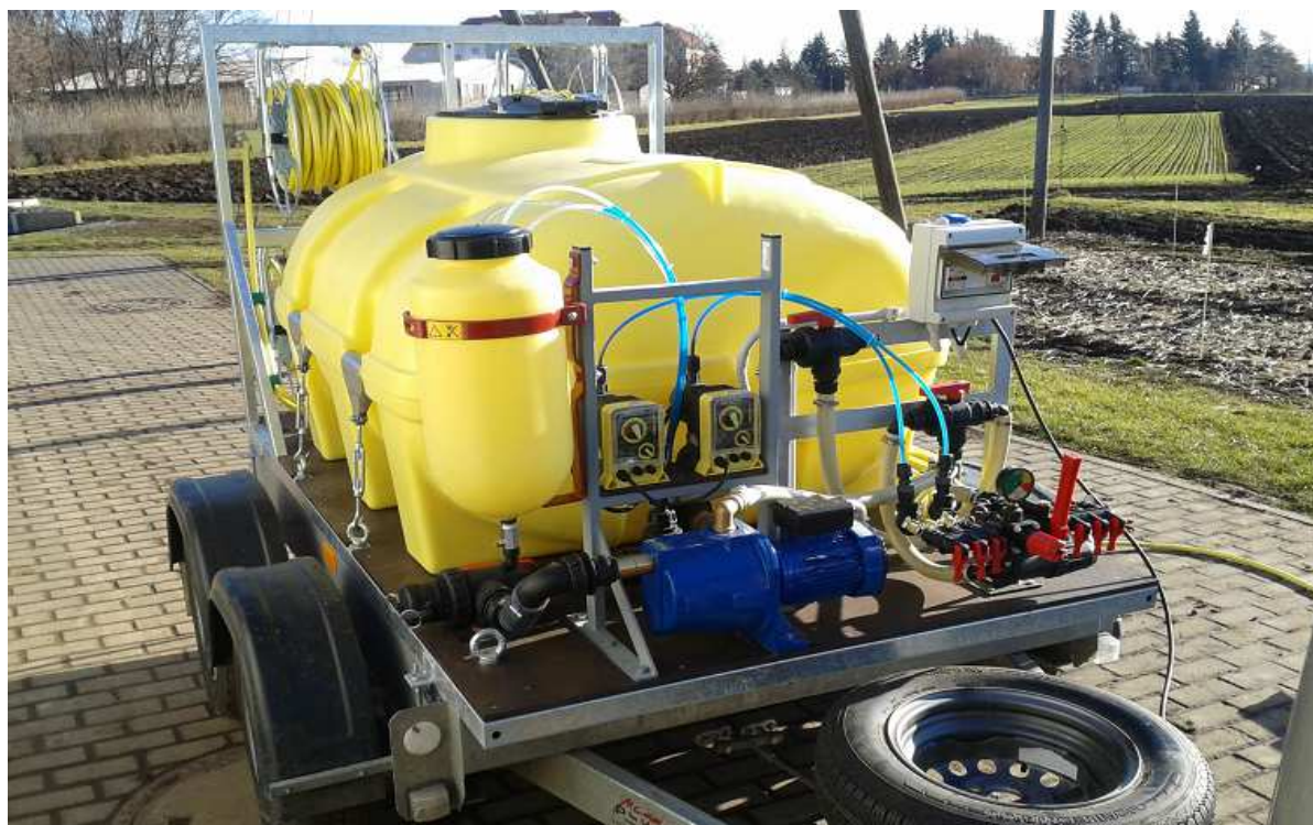
Obrázek 105- Simulátor deště vyvinutý na KZS
