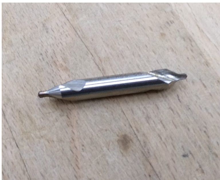
Obr. 7.1 Středící vrták HSS A bez povlaku
