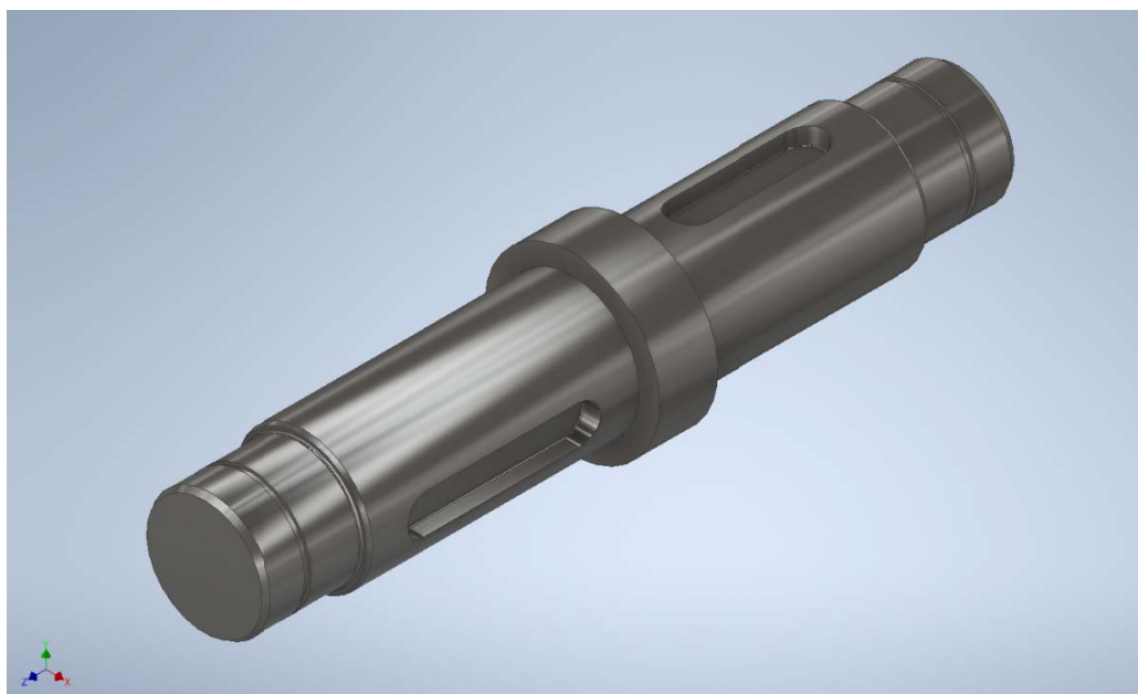
Obr. 0.2 Model vyráběné hřídele v programu Autodesk Inventor.
