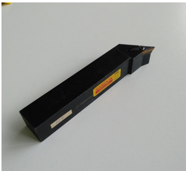
Obr. 5.5 Soustružnický nůž pro dokončování drážky F.
