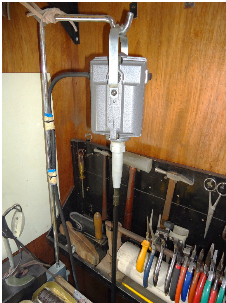
Obr. 2.3 Ruční bruska s ohebnou hřídelí [24].
