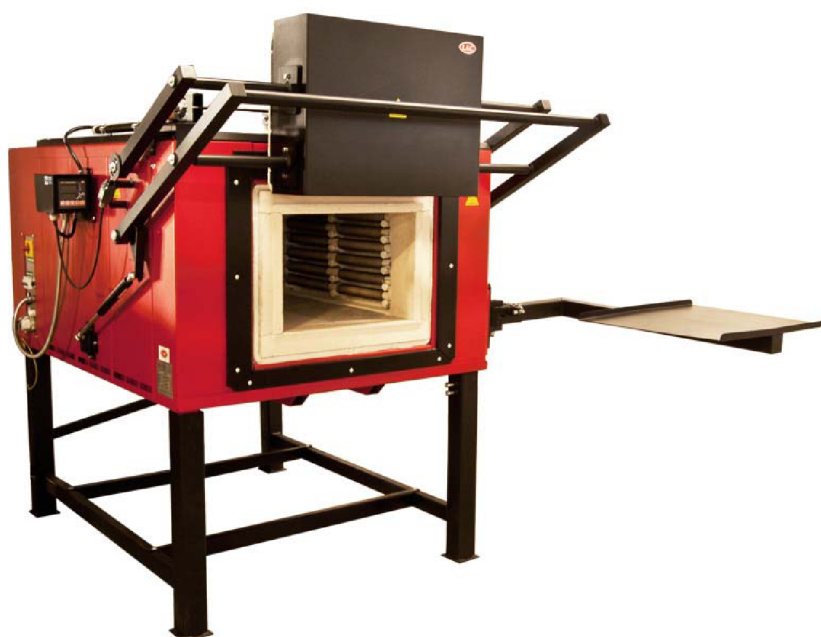
Obr. 8.1 Komorová kalicí pec PK 55/12 [16]
