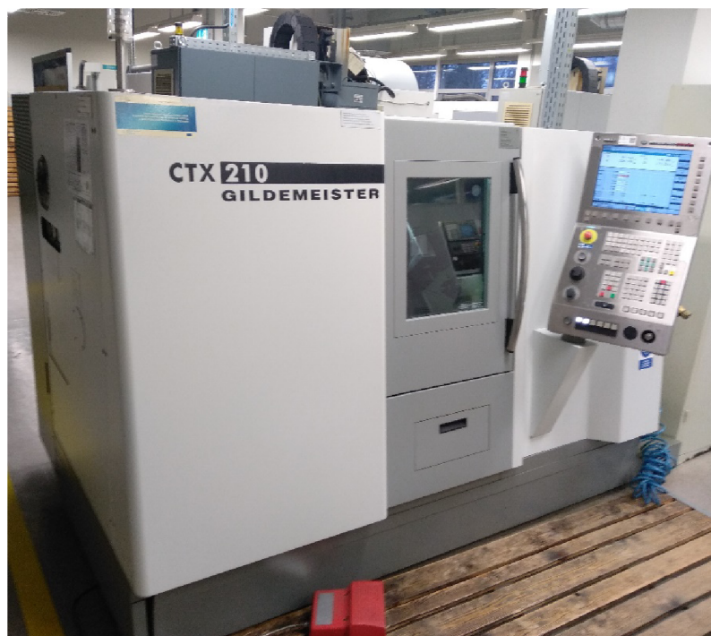
Obr. 5.2 Soustružnické centrum GILDEMEISTER CTX 210.
