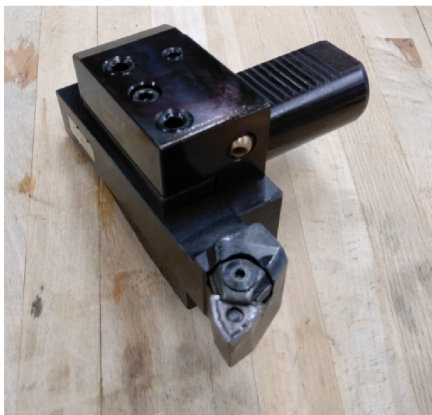
Obr. 5.3 Soustružnický nůž pro hrubování upnutý v držáku.
