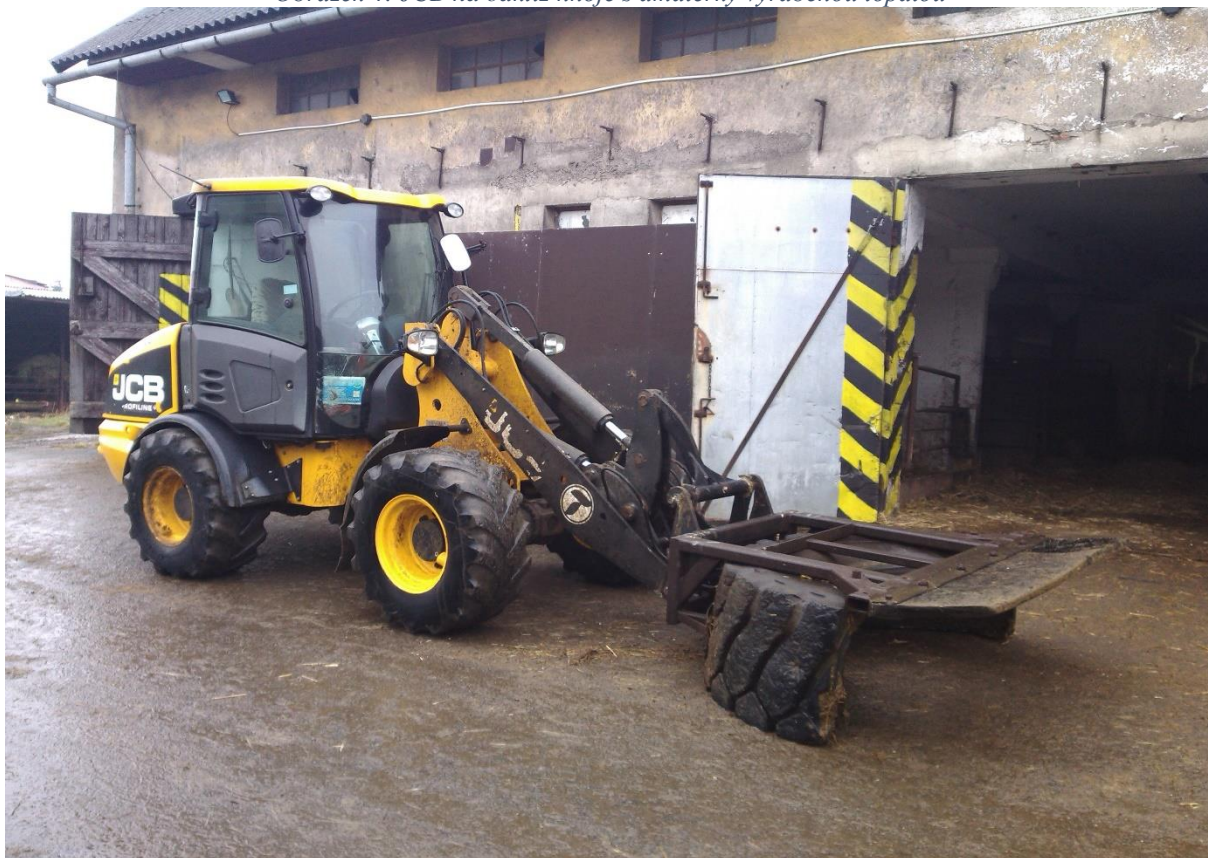
Obrázek 4: JCB na odklíz hnoje s amatérsky vyráběnou lopatou
