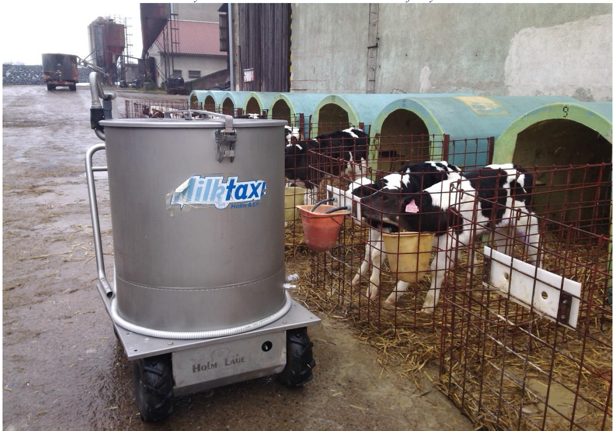
Obrázek 6: Krmný automat MilchTaxi/Milktaxi německé firmy Holm & Laue
