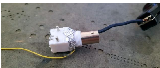
Obrázek 2.18 Ověření izolační pevnosti použitých BNC konektorů
