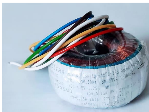
Obrázek 2.11 Zakázkově vyrobený toroidní transformátor pro datalogger
