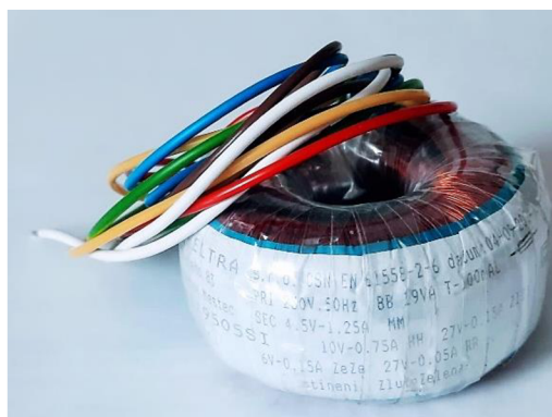
Obrázek 2.11 Zakázkově vyrobený toroidní transformátor pro datalogger
