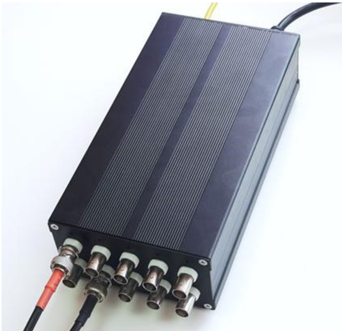
Obrázek 4.2 Finální podoba zakrytovaného dataloggeru
