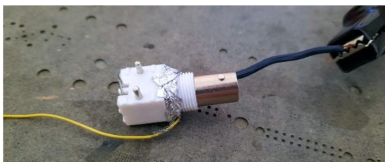
Obrázek 2.18 Ověření izolační pevnosti použitých BNC konektorů
