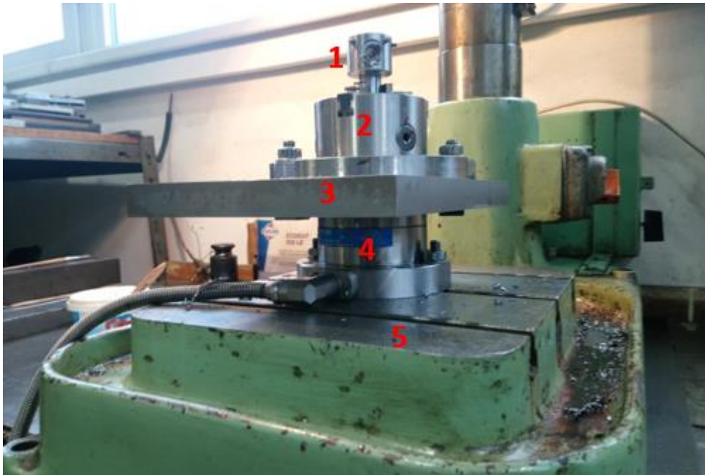
Obr. 2-4 Upnutie dynamometra. 1 – držiak na matice, 2- trojčel'usťové skľučovadlo, 3- upínacia doska, 4 – dynamometer, 5 – stôl vrtáčky.
