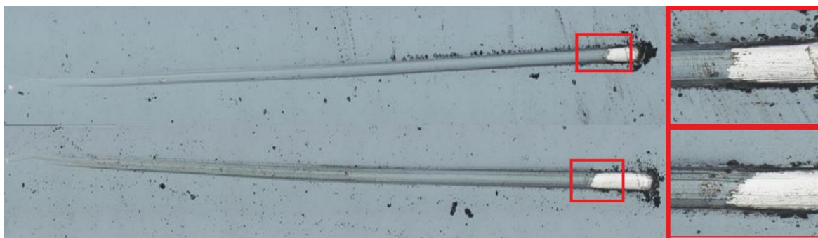
Obr. 1-25 Pohľad na povlak po scratch teste.
