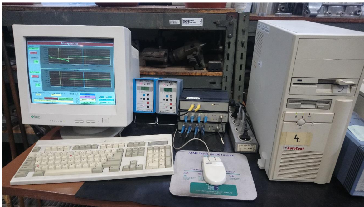
Obr. 2-2 Merací počítač a nábojové zosilňovače.
