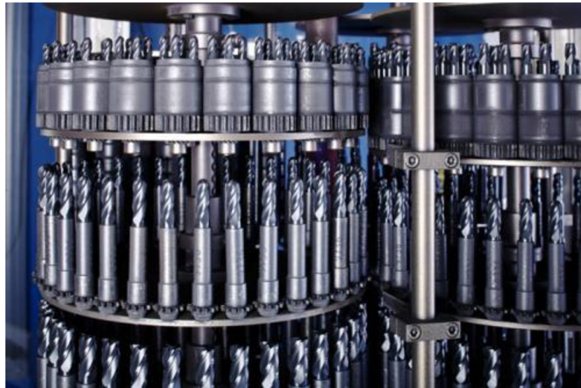
Obr. 1-8 Rotačné držiaky s nástrojmi PVD [24].
