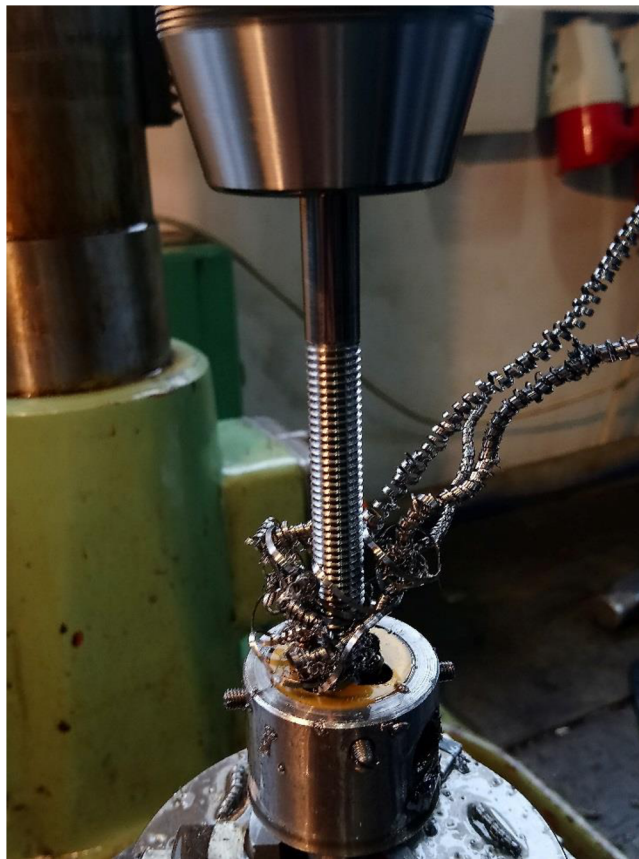
Obr. 3-10 Matica B v spätnom chode obrobku.
