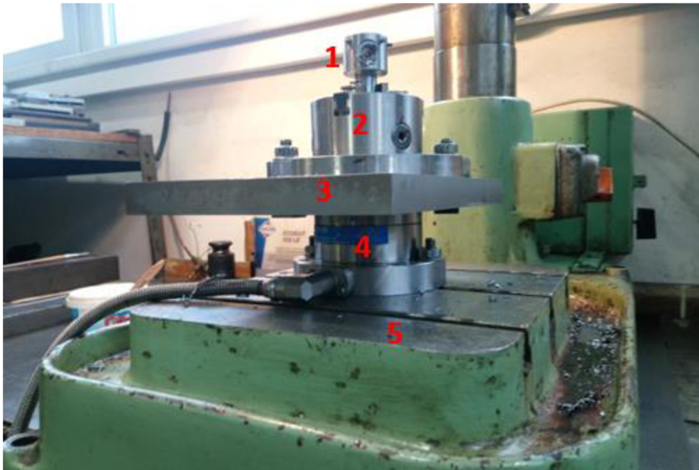
Obr. 2-4 Upnutie dynamometra. 1 – držiak na matice, 2- trojčelustové skľučovadlo, 3- upínacia doska, 4 – dynamometer, 5 – stôl vrtáčky.
