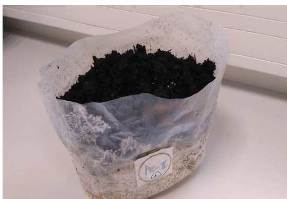
Obr. č. 2. Sáček zakrytý zeminou.
