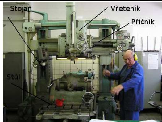
Obr. 3.21 Souřadnicová vrtačka portálová (Upraveno) [19]
