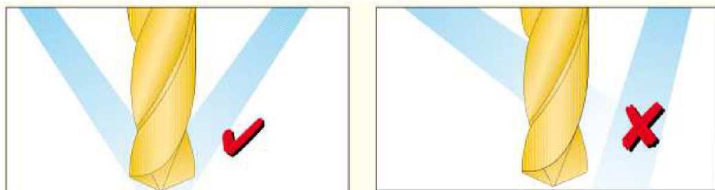
Obr. 6.4 Přívod chladicí kapaliny do řezu [15]Obr. 6.4)
