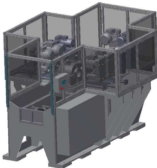
Obr. 9.2 Vzhled stroje s vnějšími ochrannými kryty
