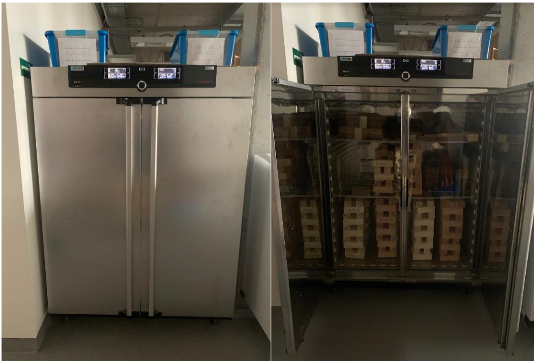
Obr. 7 Klimatizování zkušebních vzorků
