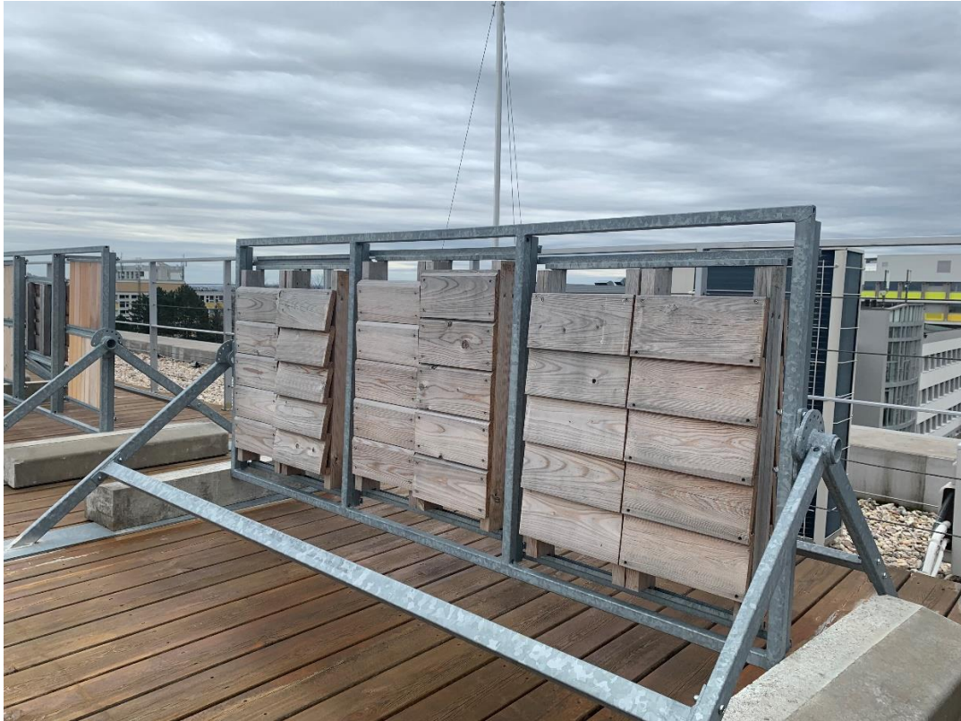
Obr. 10 Stojan se vzorky dřevěných fasád umístěný na střeše fakulty lesnické a dřevařské
