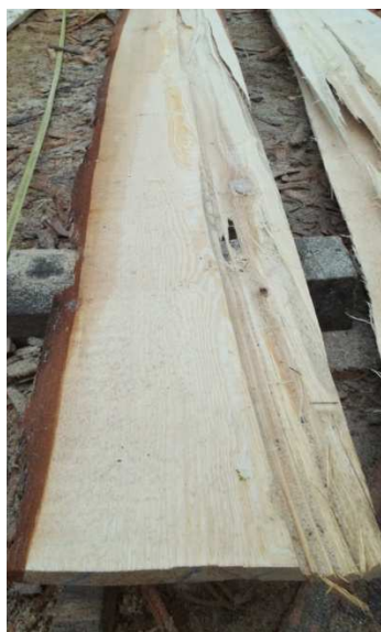
Obr. 8 Trhlina zboku, čtvrtý kus
