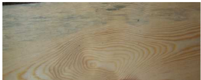
Obr. 2 Zamodráním běle (Foto autor 2015)
