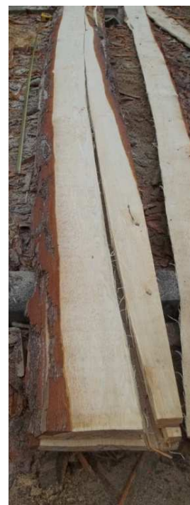
Obr. 6 Trhlina z boku, druhý kus
