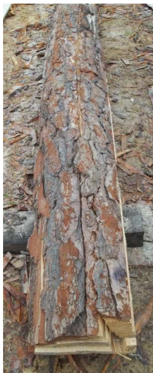
Obr. 5 Trhlina z boku, první kus
