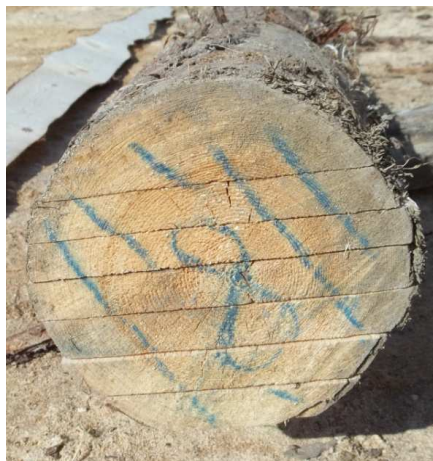
Obr. 5 Výřez poskládaný z řeziva do původního tvaru, (Foto autor 2015)
