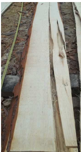
Obr. 7 Trhlina zboku, třetí kus
