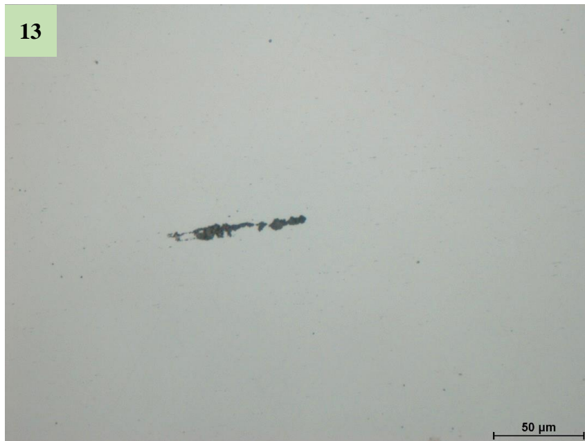
Obr. 23 Struktura drátu – Tepelně zpracován Pb 710 °C 120 m/min 500x zvětšení
