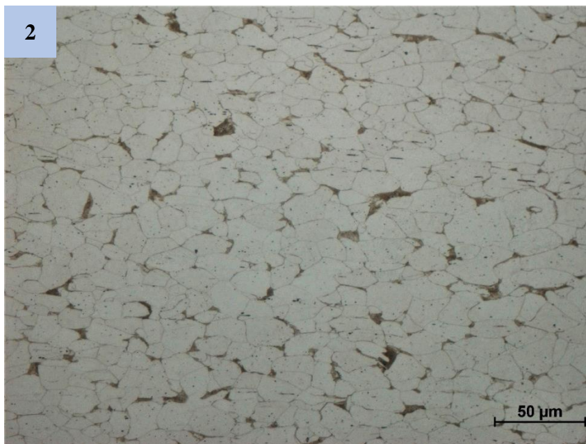
Obr. 28 Struktura drátu – 1.tah 500x zvětšení
