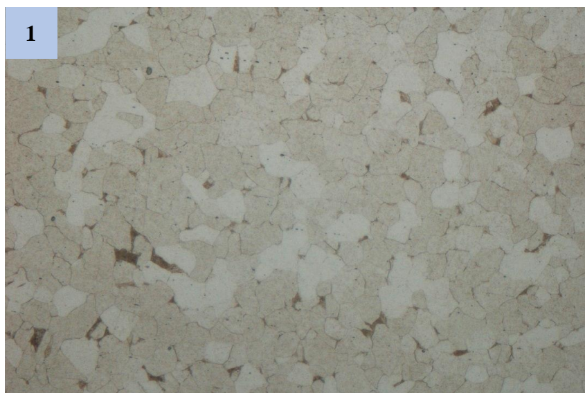
Obr. 24 Struktura drátu – válcovaný stav 500x zvětšení
