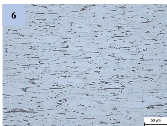
Obr. 38 Struktura drátu – 5.tah
