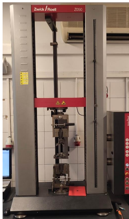
Obr. 20 Zkušební stroj Zwick model Roell Z050
