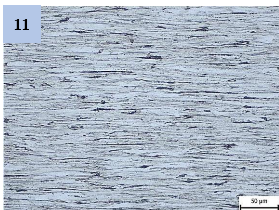
Obr. 43 Struktura drátu – Tepelně zpracován Pb 560 °C 120 m/min
