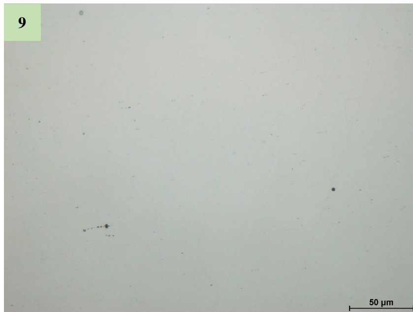
Obr. 24 Struktura drátu – 8.tah 500x zvětšení
