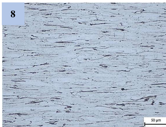
Obr. 40 Struktura drátu – 7.tah
