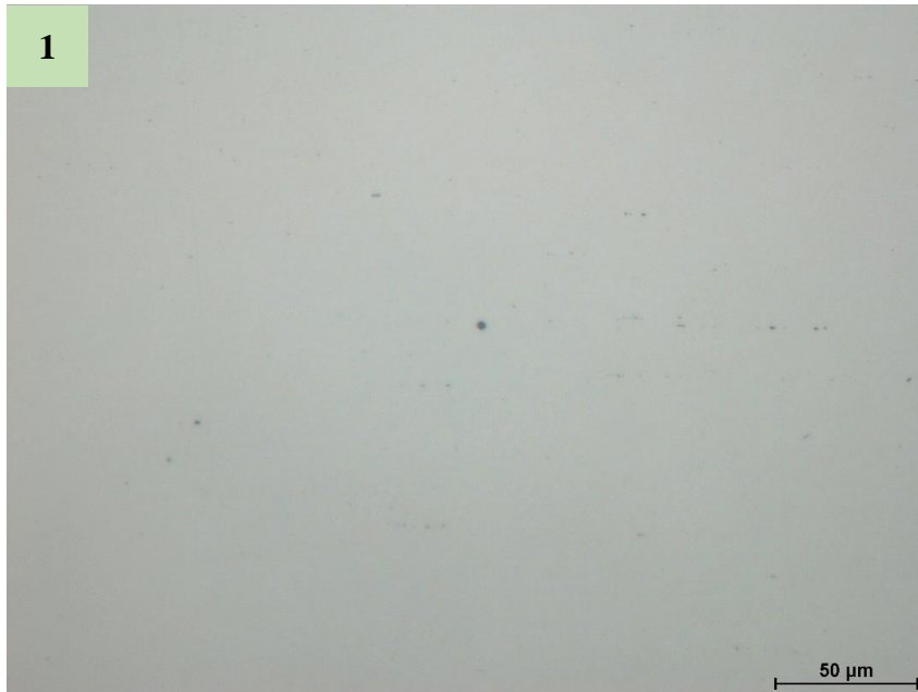
Obr. 23 Struktura drátu – válcovaný stav 500x zvětšení
