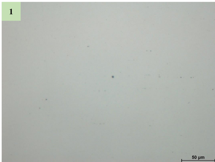
Obr. 23 Struktura drátu – válcovaný stav 500x zvětšení
