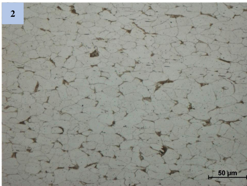
Obr. 28 Struktura drátu – 1.tah 500x zvětšení
