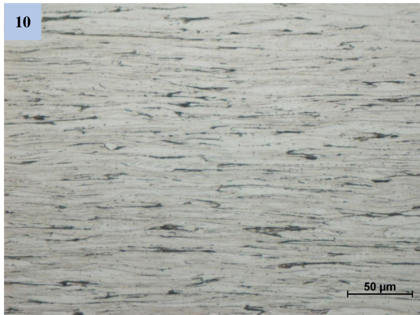
Obr. 29 Struktura drátu – Tepelně zpracován Pb 560 °C 60 m/min 500x zvětšení
