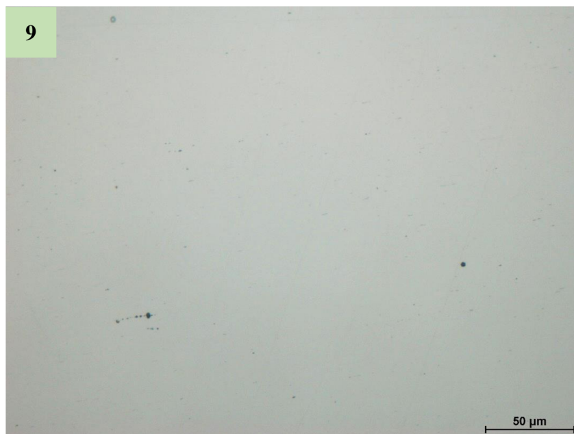
Obr. 24 Struktura drátu – 8.tah 500x zvětšení
