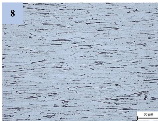
Obr. 40 Struktura drátu – 7.tah
