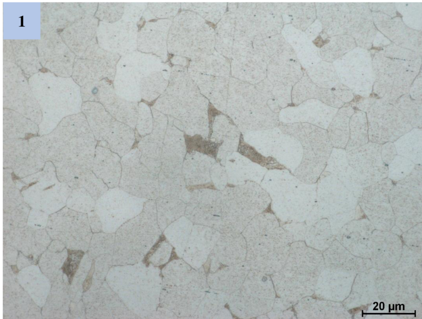
Obr. 27 Struktura drátu – válcovaný stav 1000x zvětšení
