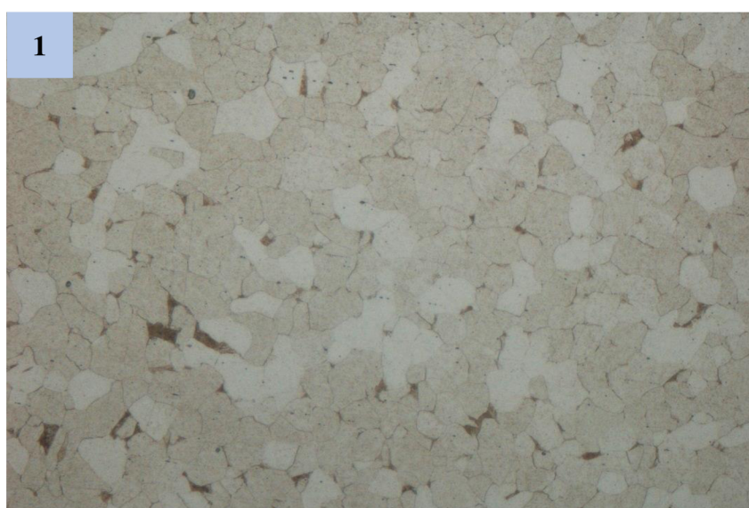
Obr. 24 Struktura drátu – válcovaný stav 500x zvětšení
