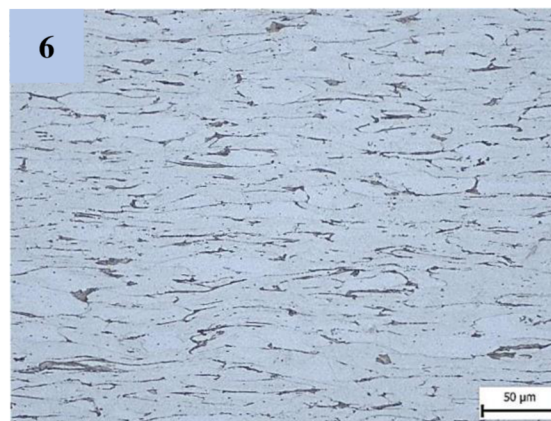
Obr. 38 Struktura drátu – 5.tah
