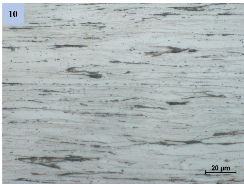
Obr. 30 Struktura drátu – Tepelně zpracován Pb 560 °C 60 m/min 1000x zvětšení
