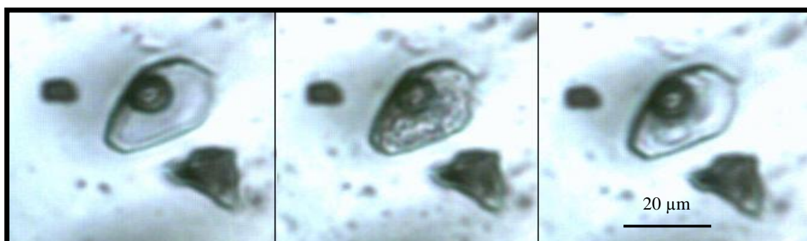
Obr. 9 – Dvoufázová FI v křemenu žilky „alpské parageneze“, nalevo FI za pokojové teploty, uprostřed vymrznutí obsahu FI při teplotě -35,0 °C, napravo tání krystalku ledu při teplotě -2,2 °C, vzorek Z3.
