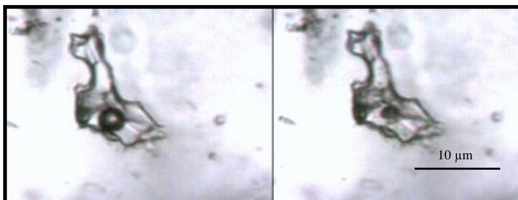
Obr. 7 – Dvofázová FI v křemeni žilky „alpské parageneze“, nalevo FI za pokojové teploty, napravo vymrznutí FI při teplotě -42,3 °C, vzorek Z3.
