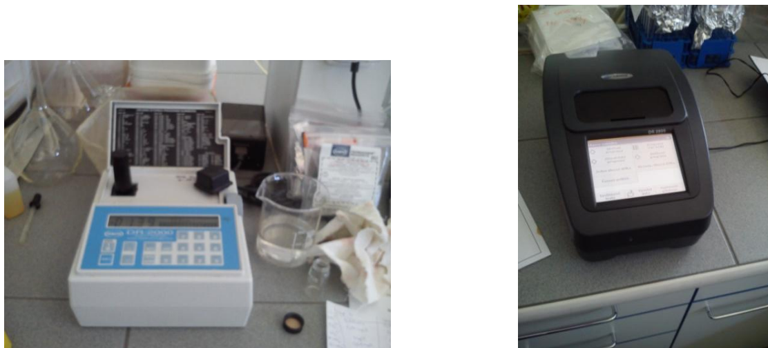
Obr. 13: Spektrofotometr DR 2000 (vlevo) a DR 2800 (vpravo) (foto: autorka).
