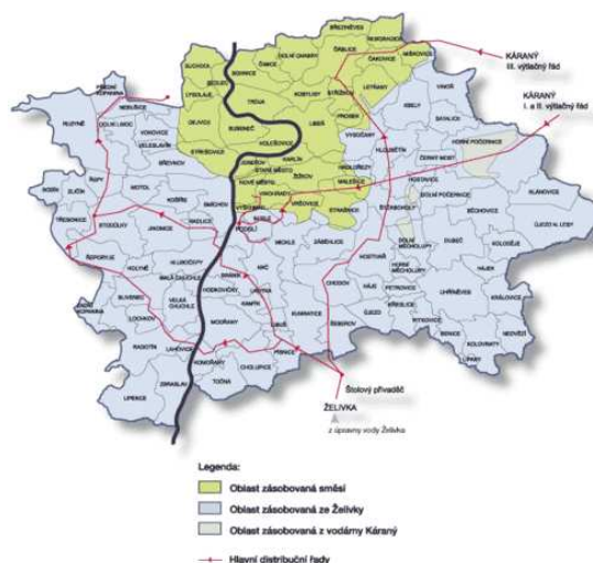
Obrázek 1: Schéma zásobování pitnou vodou Prahy podle úpraven vody 4
