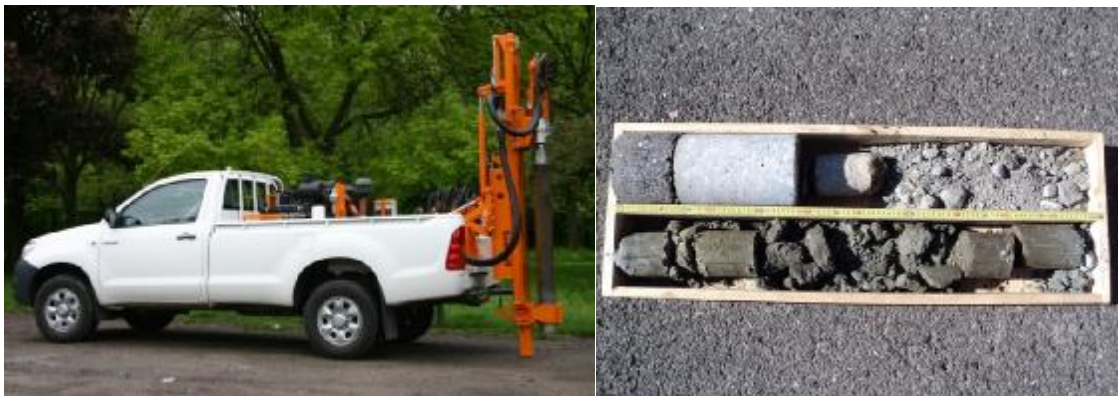
Obrázek 8 – Souprava pro odběr geotechnických sond a odebraná sonda
