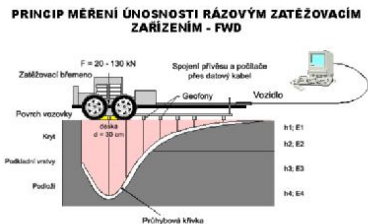
Obrázek 6 – Princip měření únosnosti rázovým zařízením FWD (Kudrna, 2007)
