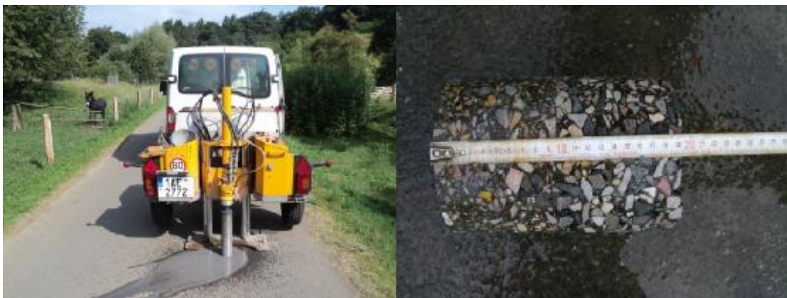
Obrázek 7 – Souprava pro odběr jádrových vývrtů a odebraný jádrový vývrt
