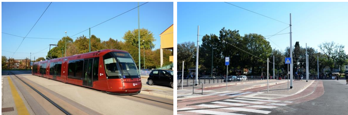
Obr. 11 Ačkoliv řada měst plánuje tramvaje na pneumatikách přestavět na systémy klasické tramvaje, například italské Mestre svůj provoz „na pneumatikách“ i nadále rozvíjí. Na snímku vlevo byla vyfotografována tramvaj na pneumatikách na provozní lince, snímek vpravo zachytil budovanou trasu, která končí v Benátkách (Kameníček, 2014).
