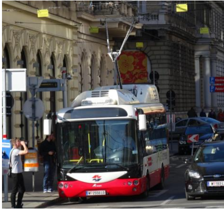
Obr. 20 Odlišné technologie elektrobusesů – na obrázku vlevo průběžně nabíjený vůz ve Vídni, vpravo elektrobuses v Hradci Králové s klasickým nabíjením mimo pravidelný provoz v depu (Kameníček, 2013).
