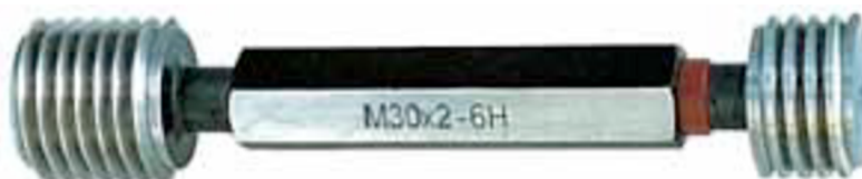
Obr. 4.4 Příklad kalibru pro jemný závit tolerance 6H [17]
