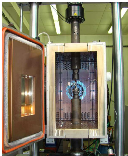
Obr. 5.7 Teplotní komora do 540 °C [109]
