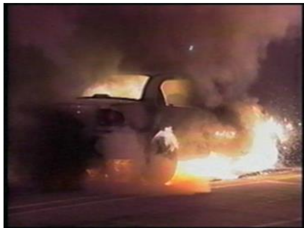
Obr. 19, dvě minuty a dvacet vteřin po zahájení experimentu, vůz s benzínovou nádrží [89]
