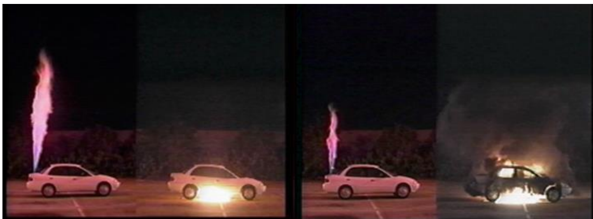
Obr. 18, vlevo situace těsně po zažehnutí nádrže, vpravo po 1 minutě od zahájení experimentu (vlevo vůz vybavený vodíkovou nádrží, vpravo nádrží benzínovou) [89]
