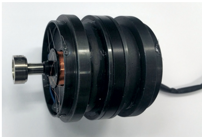
Obrázek 11 | Použité pohybové zařízení (bez pouzdra a s namontovaným zářičem).
