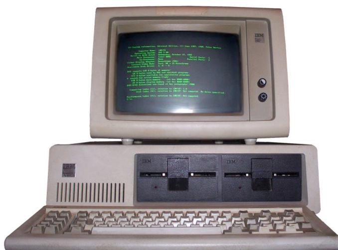
Obrázek 5: IBM PC (IBM 5150) se zeleným monochromatickým monitorem (IBM 5151) a operačním systémem MS-DOS 5.0 [18]
