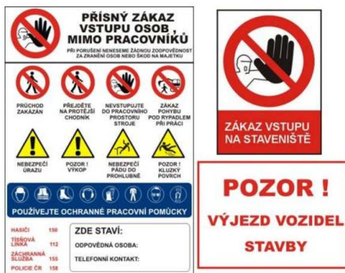
Obrázek 75: Výstražná cedule upravující vstup na staveniště
