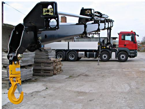
Obrázek 55: Nákladní automobil MAN 35.400 s hydraulickou rukou HIAB 477 E-6
