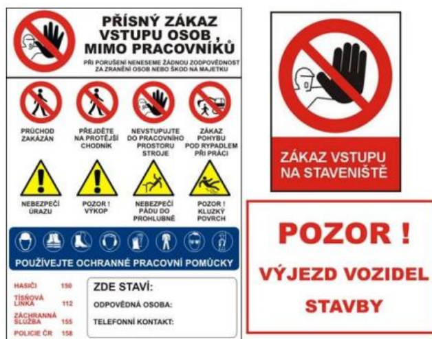
Obrázek 10: Výstražná cedule upravující vstup na staveniště
