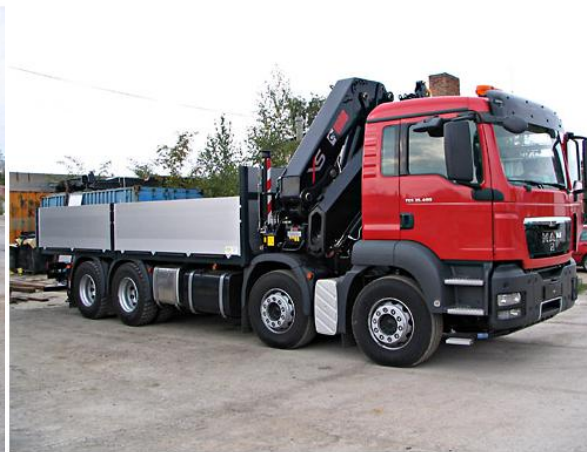
Obrázek 55: Nákladní automobil MAN 35.400 s hydraulickou rukou HIAB 477 E-6
