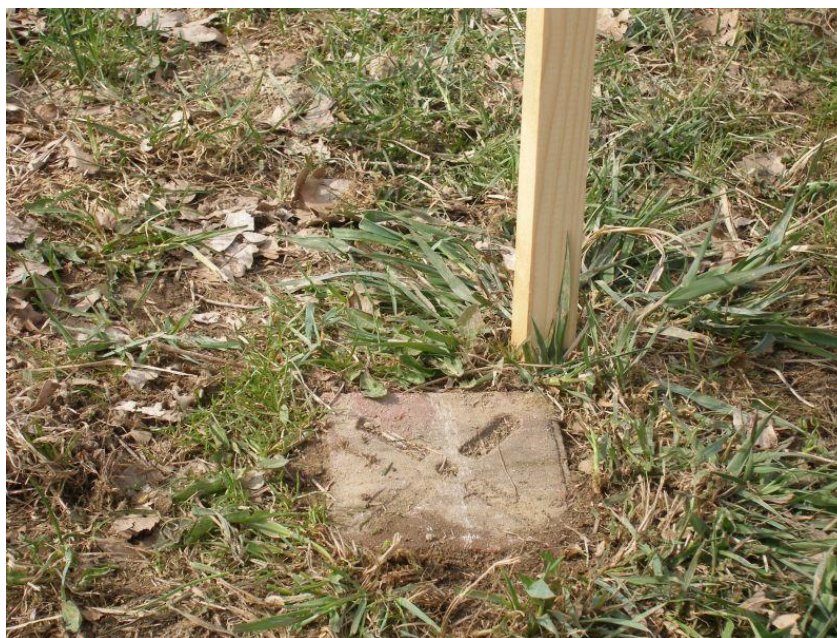
Obrázek 6: Ukázka stabilizace nově zřízeného bodu PPBP č.511
