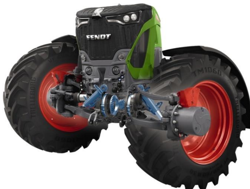
Obr. 7 Nezávisle odpružená přední náprava řady traktorů Fendt 900 [14]
