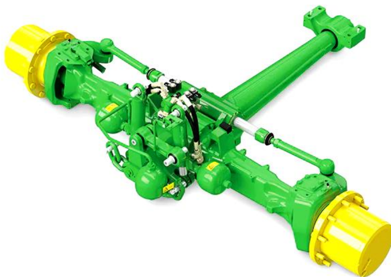
Obr. 6 Odpružená přední náprava řady traktorů John Deere 6R [12]
