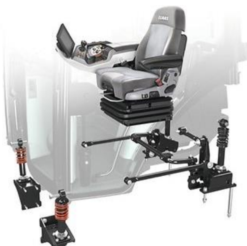
Obr. 9 Mechanické odpružení na čtyřech jednotkách odpružení [17]
