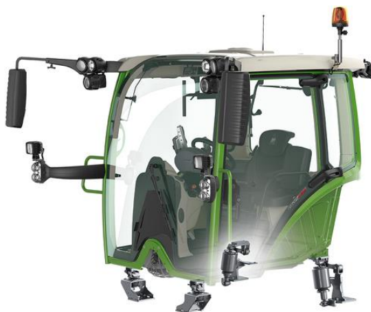
Obr. 10 Pneumatické odpružení s předním uložením pomocí silentbloků [19]
