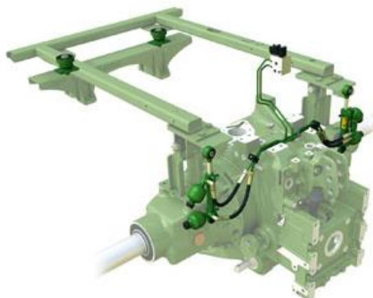
Obr. 11 Hydropneumatické odpružení řady traktorů John Deere 6R [20]
