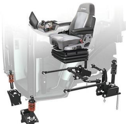
Obr. 9 Mechanické odpružení na čtyřech jednotkách odpružení [17]
