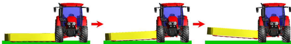
Obr. 52 Průběh zdvihu neseného žacího stroje pomocí jednočinné jednotky
