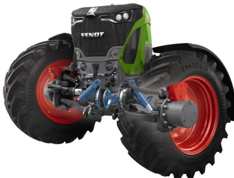
Obr. 7 Nezávisle odpružená přední náprava řady traktorů Fendt 900 [14]
