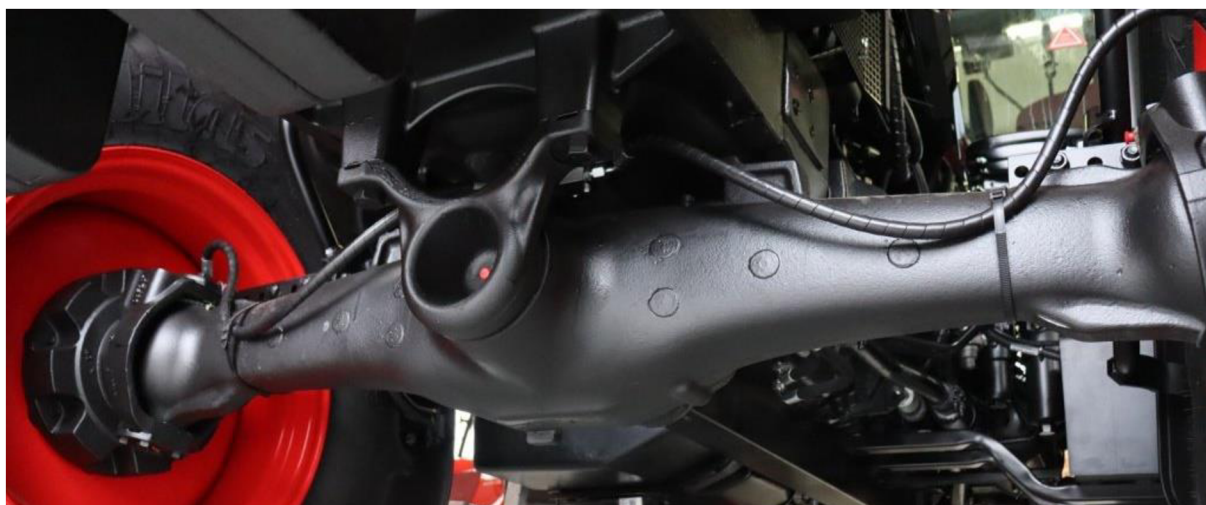
Obr. 5 Neodpružená přední náprava řady traktorů Zetor Proxima GP [10]
