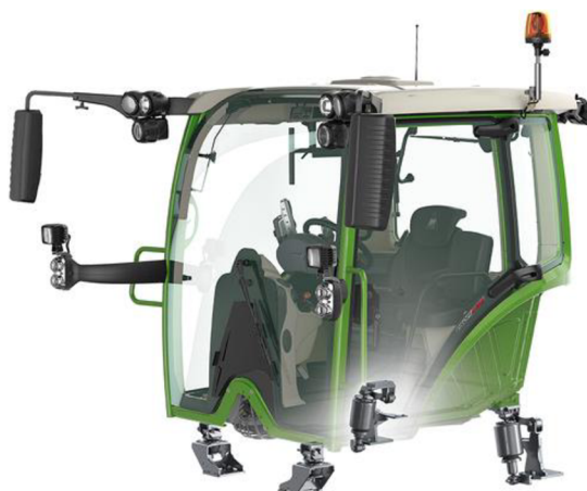
Obr. 10 Pneumatické odpružení s předním uložením pomocí silentbloků [19]
