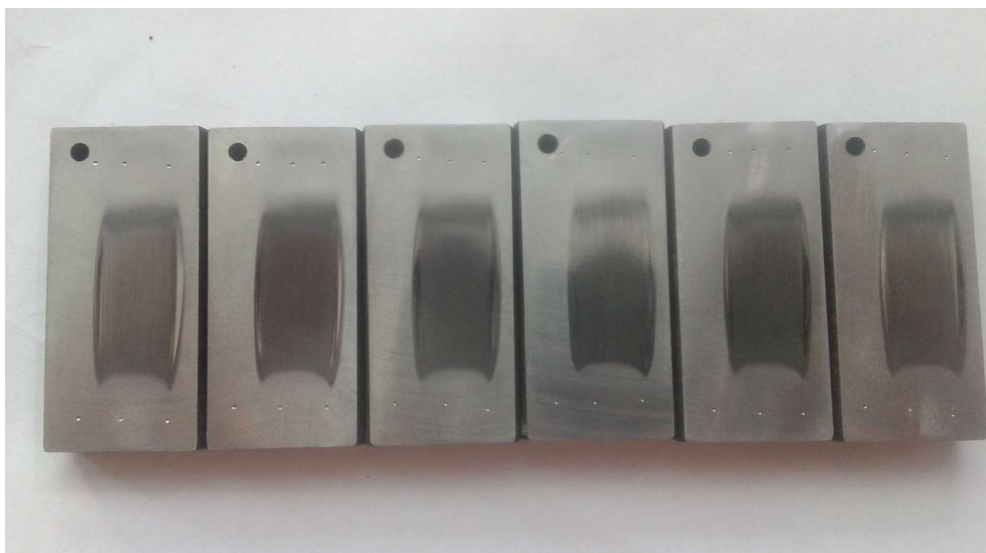
Obrázek 4.15: Vzorky pro abrazivní zkoušky po zkouškách na abrazivní odolnost proti opotřebení metodou ASTM G65
