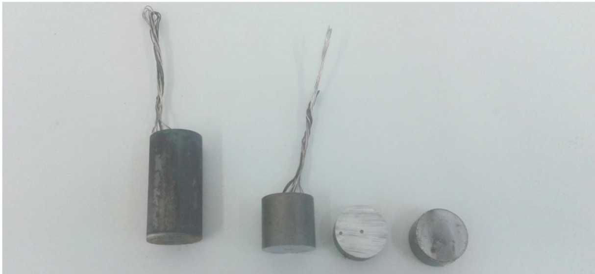
Obrázek 4.3: Příprava vzorku pro měření vzdálenosti termočlánků: vlevo - celý vzorek, vpravo - rozřezaný vzorek
