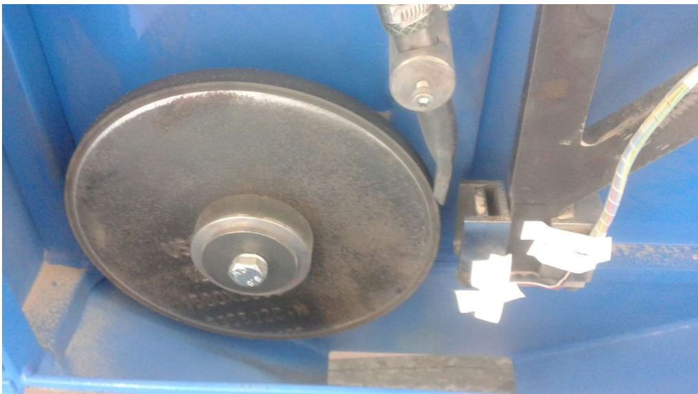
Obrázek 4.14: Měření vzorků na odolnost proti abrazivnímu opotřebení
