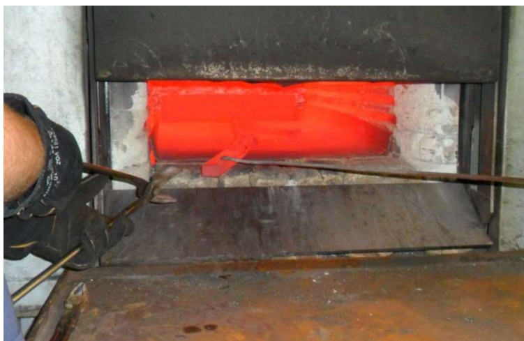
Obrázek 4.18: Vyjmutí dláta po ohřevu z pece
