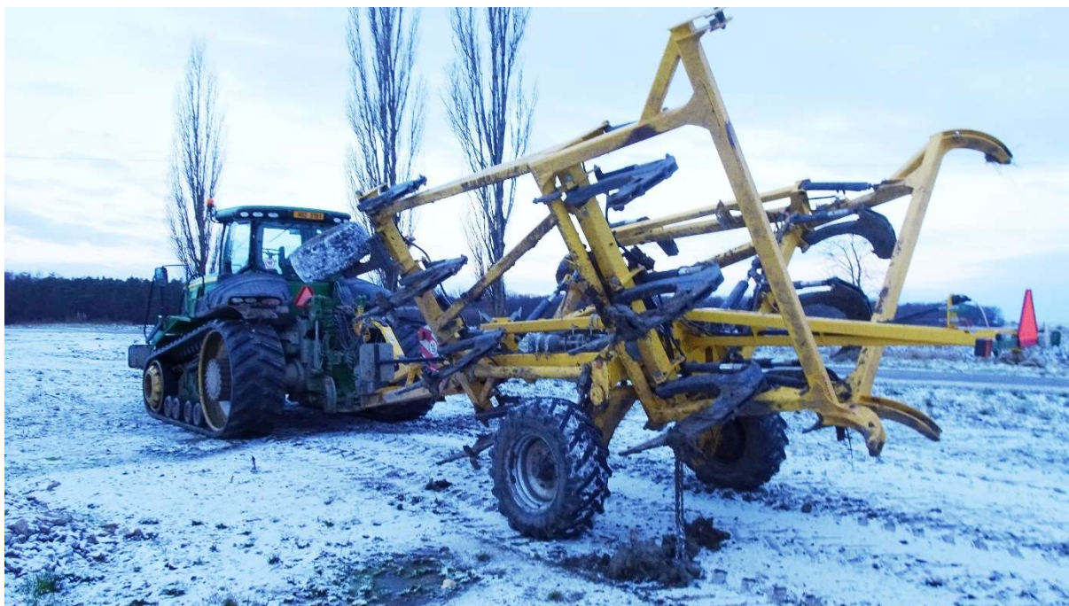
Obrázek 4.22: Tažný prostředek s agregací stroje pro zpracování půdy během rozkládání do pracovní polohy stroje
