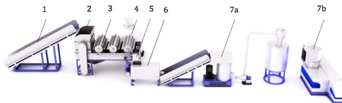
Obrázek 9 Linka na mletí, praní a sušení PE fólií: 1 – dopravníkový pás, 2 – nožový mlýn, 3 – sedimentační vana s čelisti, 4 – čistička (filtrace vody s chemickou úpravou), 5 – odvodňovací šnek, 6 – ždímací šnek, 7a – aglomerátor a silo, 7b – regranulační linka [18]
